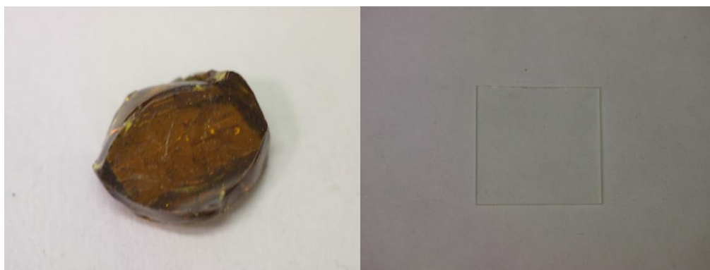
Obrázek 69: Objemové sklo (vlevo) a čerstvě připravená tenká vrstva \text{Ge}_{25}\text{S}_{75} (vpravo) deponovaná metodou spin-coating.
