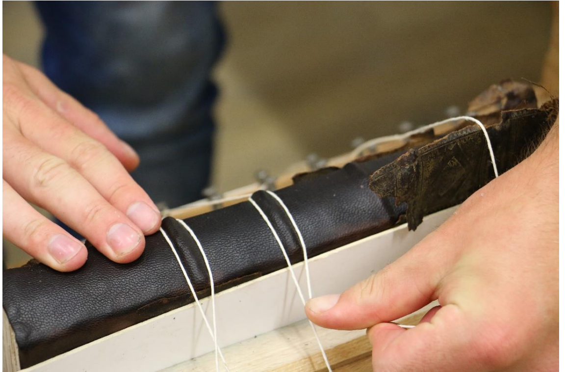
Obr. – 64 vyvázovanie chrbta knihy po aplikácii usne
