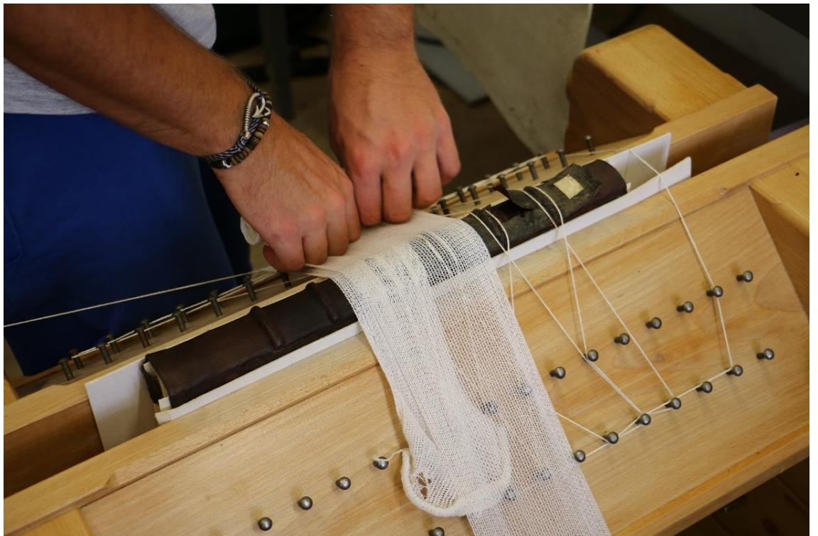
Obr. – 65 lepenie pôvodnej usne na chrbát knihy
