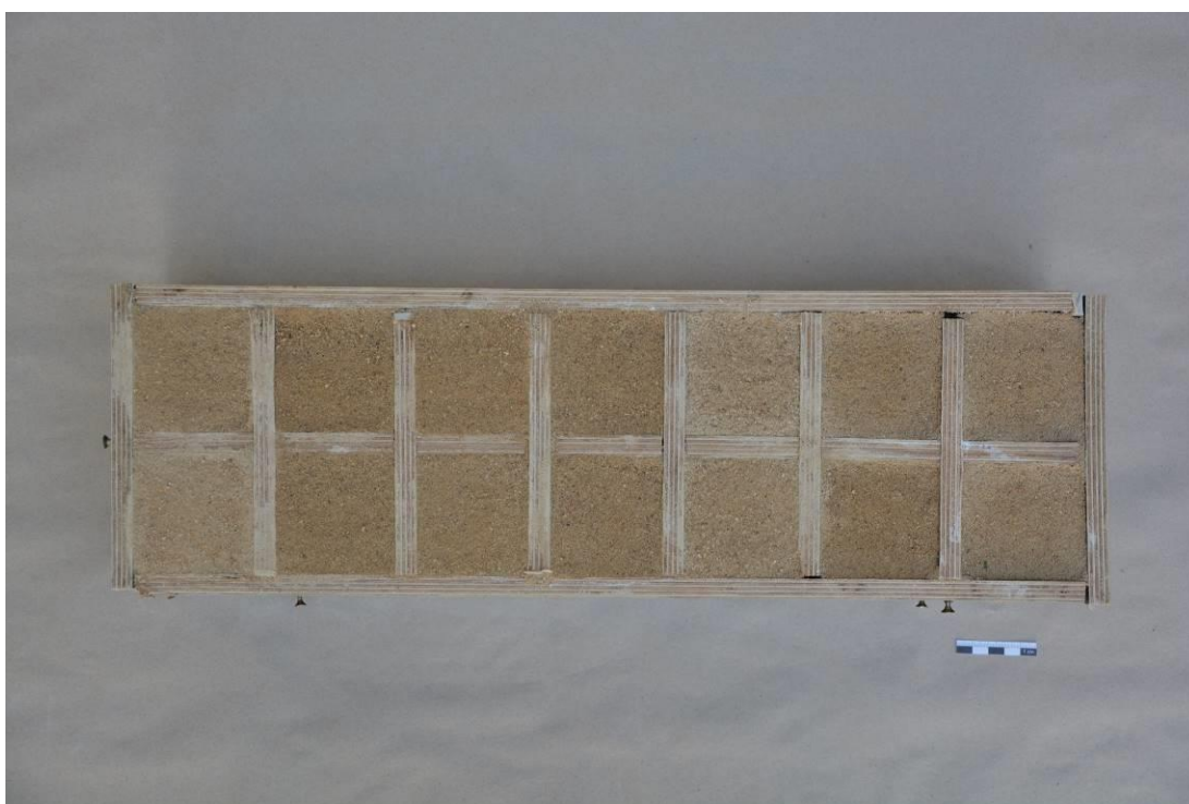
Obr. 19 Výdusky v rozebíratelné konstrukci
