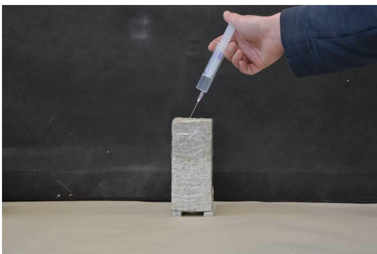
Obr. 25 Ukázka napouštění injekční stříkačkou – Kutnohorský vápenec
