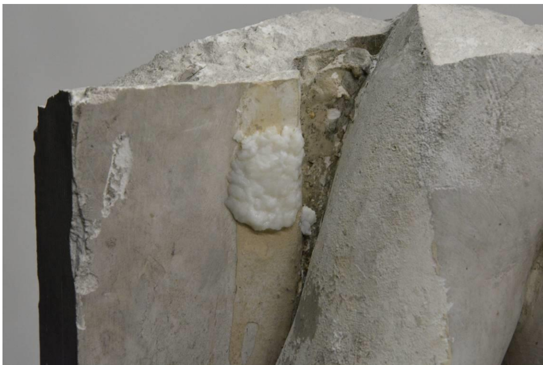
Obr. 106 Socha alegorie umění – čištění pomocí chloroformu nasyceného v zábalu práškového arbocehu
