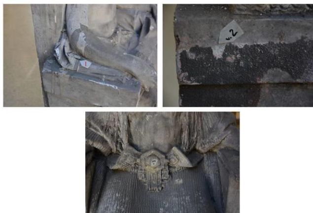
Obr. 3 a-c: Detaily míst odběru vzorků V.1.1 (Allegorie Umění), V.2 a V.3 (Allegorie Průmyslu). Detail místa odběru vzorku V.4 nebyl zadavatelem upřesněn. Nános červeného nánosu (V.4) se prakticky vyskytuje na celé ploše objektu (viz. např. snímek 3c). Foto: J. Škarvada, stav před restaurováním, 02/2017.
