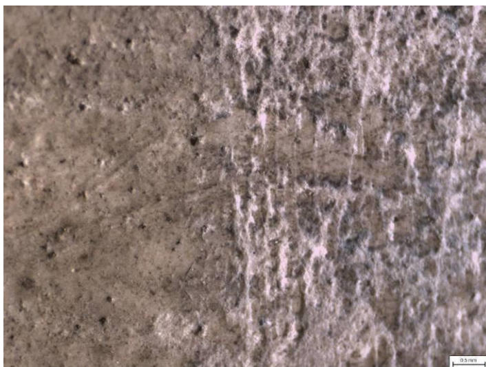
Obr. 9 Kombinovaná guma pryž červeno modrá 6521 / 60- KOH-I-NOOR – použitá modrá část s příměsí pemzy
