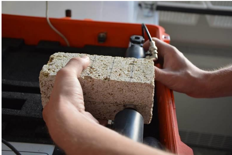
Obr. 20 Měření ultrazvukovou transmisí
