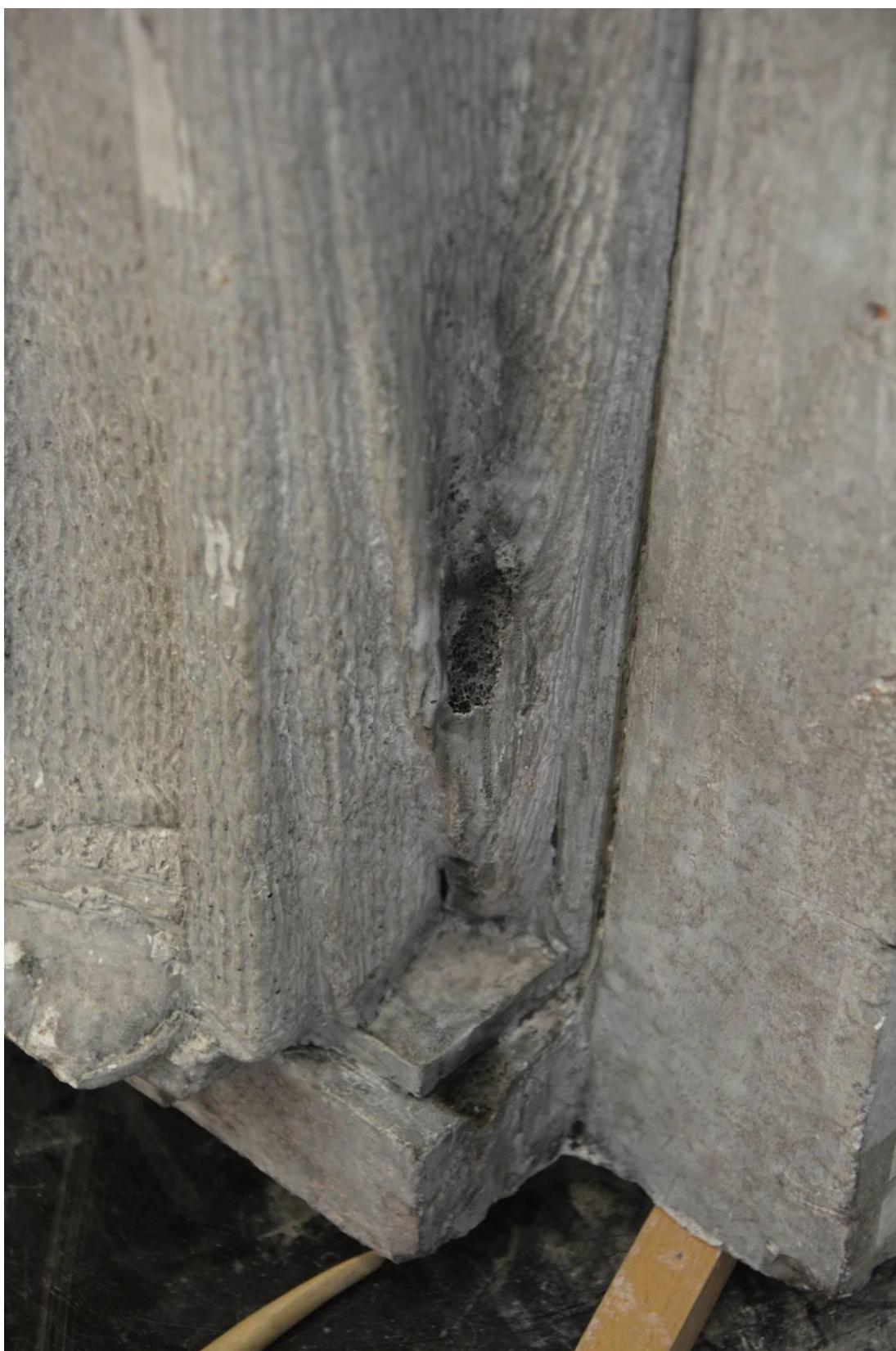
Obr. 87 Socha alegorie průmyslu – vymytí sádry způsobené tekoucí vodou
