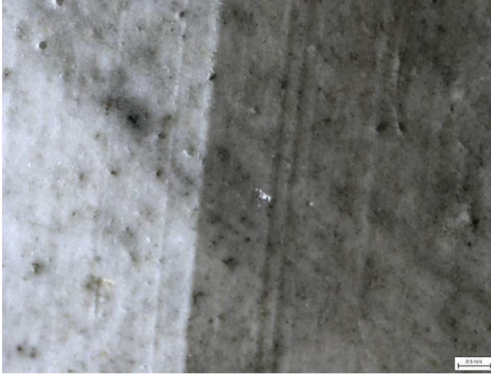
Obr. 11 Mikroabrazivní metoda čištění – pískování
