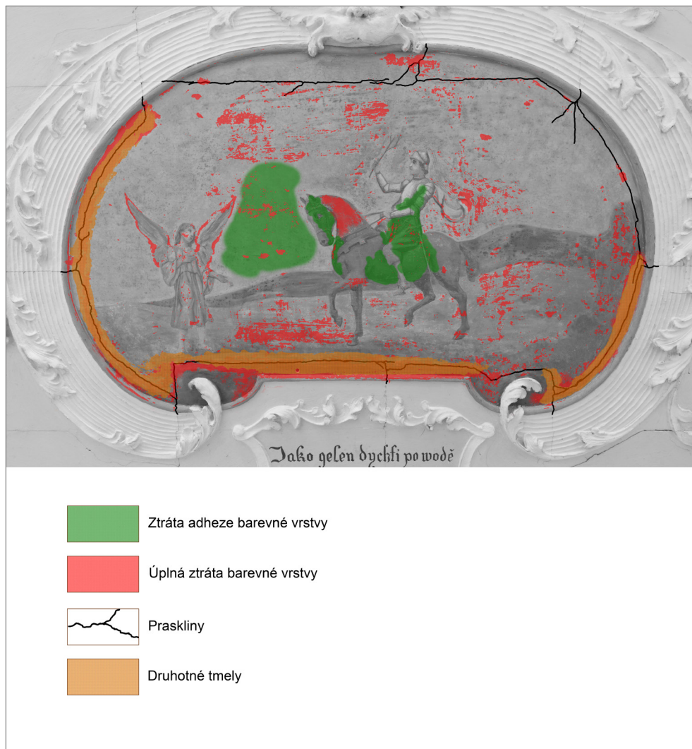
Obr.41 Grafická dokumentace - poškození malby.
