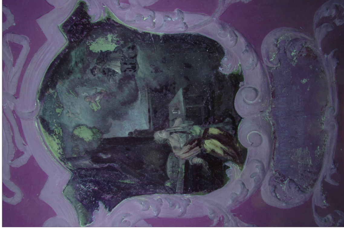
Obr. 50 Průzkum v odraženém UV světle. Na fotografiích jsou patrné světle luminující oblasti se ztrátou barevné vrstvy.
