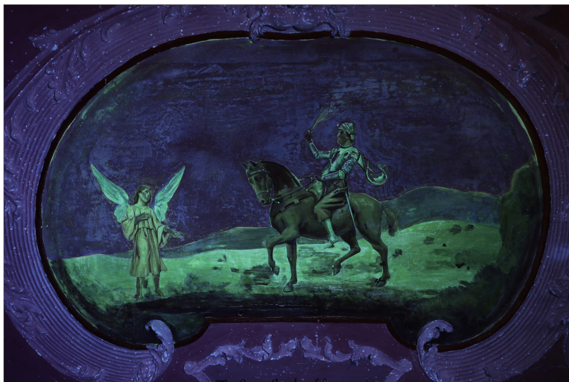
Obr.07 Snímek přemaleb výjevu v odraženém UV světle. Na malbě jsou patrné tmavě fialové oblasti přemaleb zejména na spodní části výjevu, v oblasti malby oblohy a lokální přemalby na postavě jezdce a krajiny.
