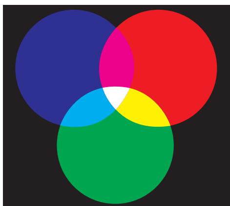
Obr. 16: Aditivní mísení barev RGB
