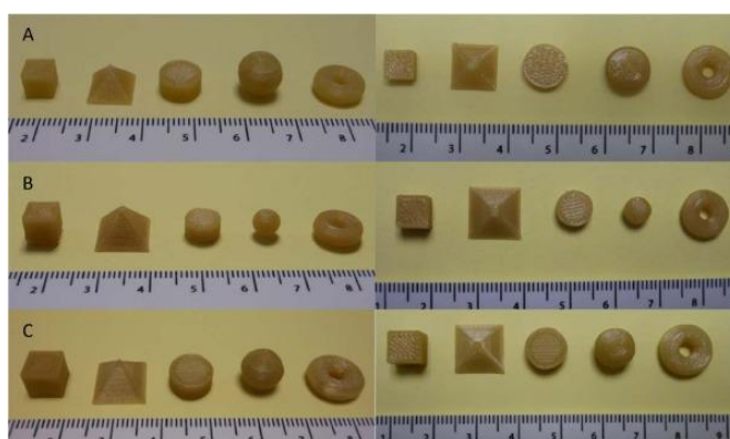
Obr. 7: Geometrické tvary 3D tablet (v cm) při konstantním povrchu (A), konstantním poměru hodnot plocha povrchu/objem (B) a konstantní hmotnosti (C)[53]
