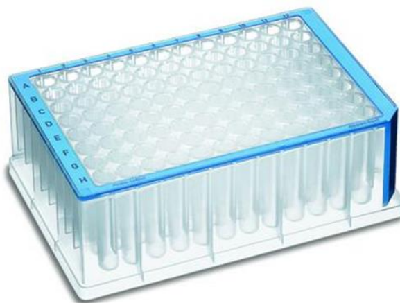
Obr. č. 10: Deska s jamkami pro aplikaci 96 vzorků [40]
