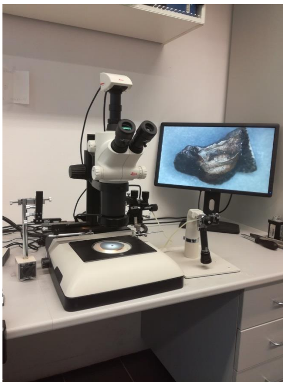
Obrázek 7. Optický mikroskop LEICA S8 APO s digitální kamerou MC120 HD.
