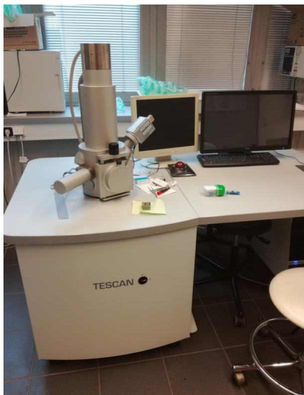
Obrázek 6. Elektronový mikroskop VEGA3 SBU doplněný rentgenovým mikroanalýzátorem Quantax.
