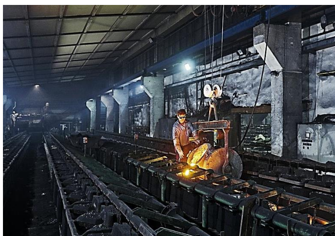
Obrázek 5: Odlévání na dopravnících linkdy UNIVERSAL KFA 20
