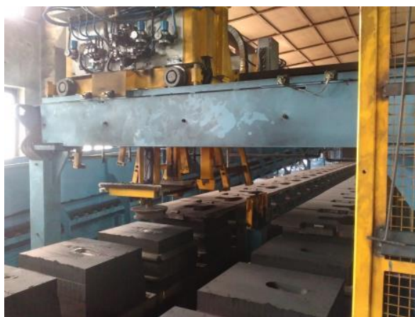
Obrázek 9: Linka DISA MATCH – manipulátor s žakety a závažími
