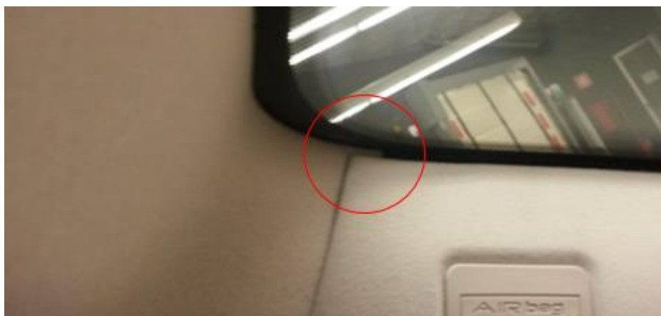
Obrázek 14: Rozměrová vada – špatné napojení na navazující komponent
