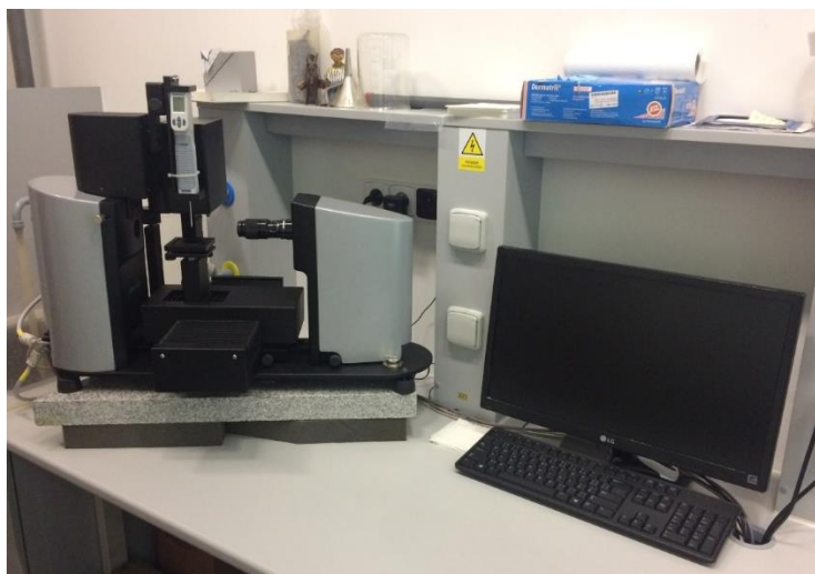
Obr. 8: Přístroj Theta, sloužící k měření kontaktních úhlů a povrchového napětí.
