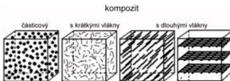
Obrázek 2 Rozdělení kompozitních materiálů podle geometrického tvaru výztuže [1]
