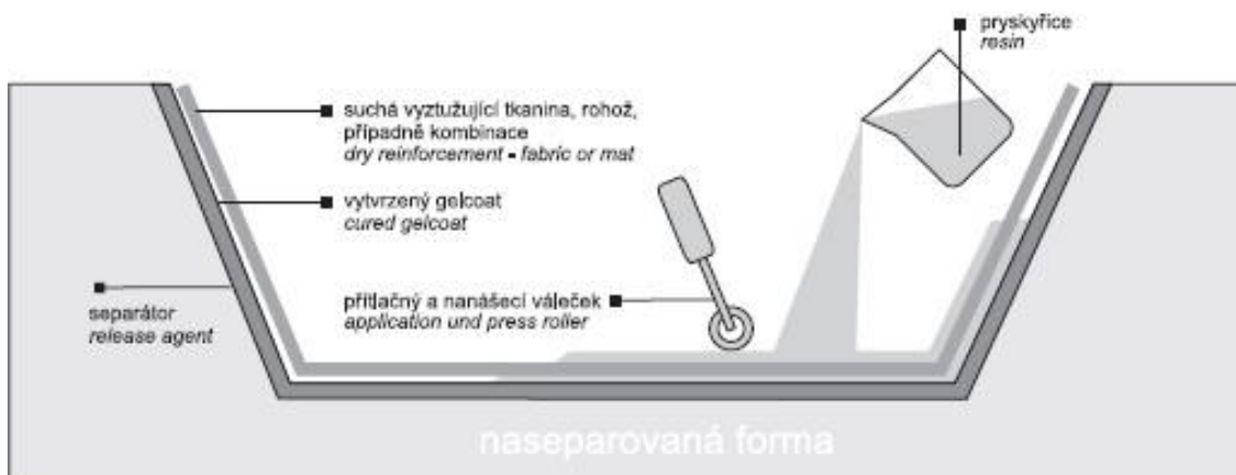
Obrázek 20 Příklad kontaktního laminování [29]
