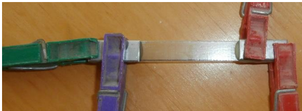
Obrázek 30 Lepení plechů na skelném vzorku
