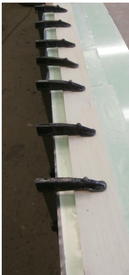
Obrázek 27 Zatížení uhlíkové tkaniny
