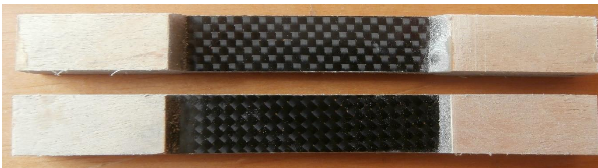
Obrázek 31 Vzorky sendviče uhlík-korek z pohledu tkaniny 98 g/m 2 pod úhly 90° a 45°
