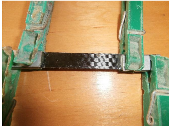
Obrázek 29 Lepení plechů na uhlíkovém vzorku
