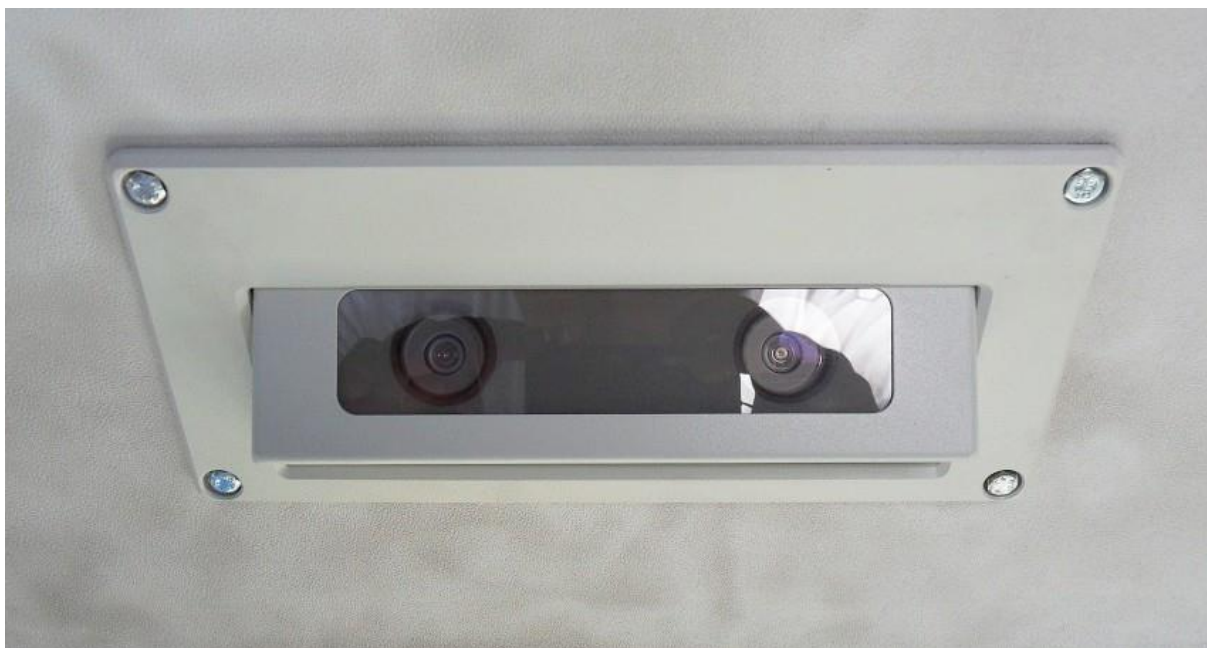
Obrázek 2 Snímač systému automatického počítání cestujících (Infotron, 2015)
