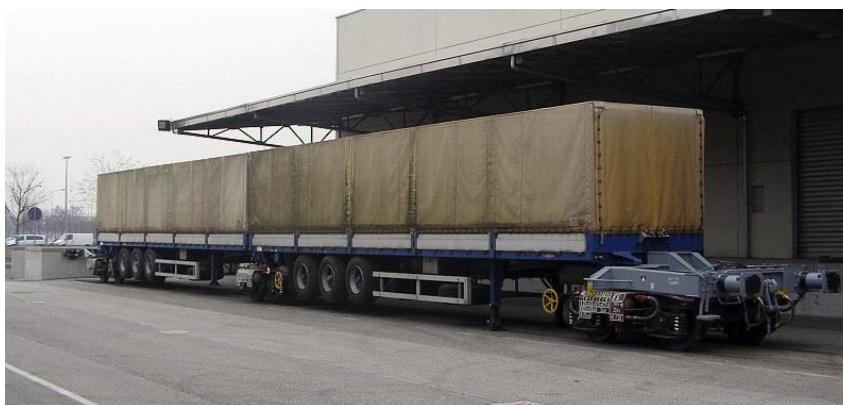
Obrázek 8 Sestava dvou návěsů na železničních podvozcích (K-report, 2007)
