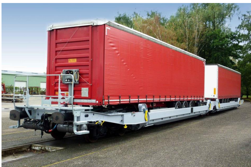
Obrázek 6 Silniční návěsy na železničním voze (Railweb, 2016)
