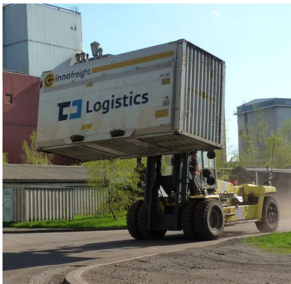
Obrázek 3 Vnitrozemský kontejner (ČD Logistics, 2013)
