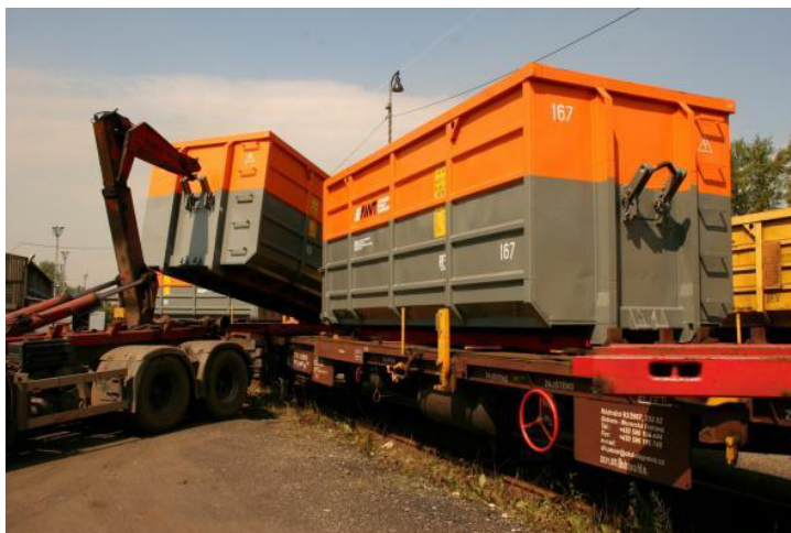
Obrázek 4 Překládka kontejneru ACTS (AWT, 2012)
