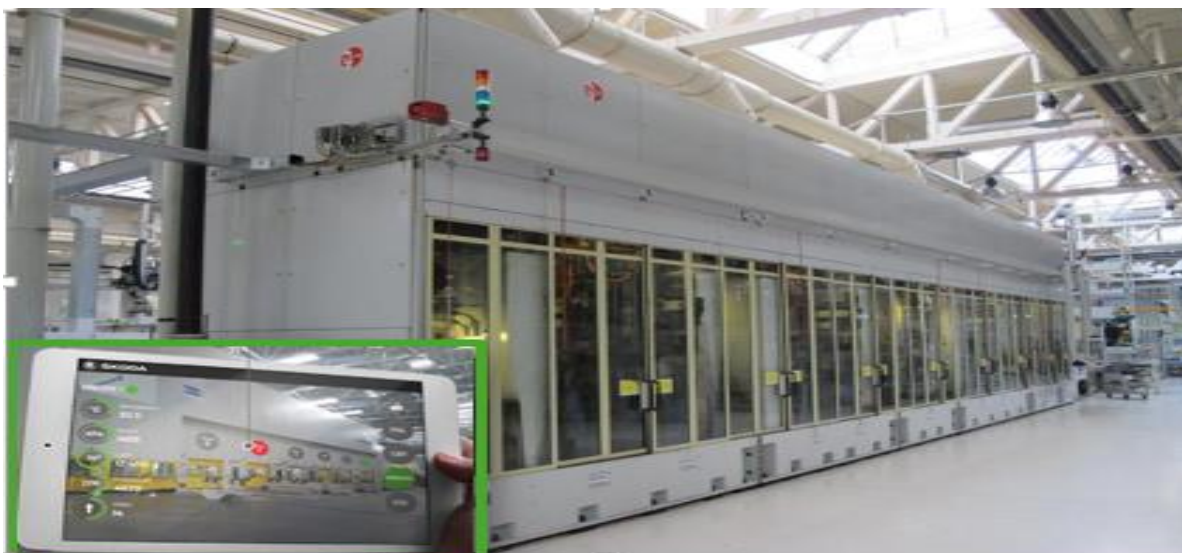
Obrázek 15 Reálné znázornění rozšířené reality na zařízení Gehring (autor; ŠKODA AUTO, 2017; FOXON, 2017)
