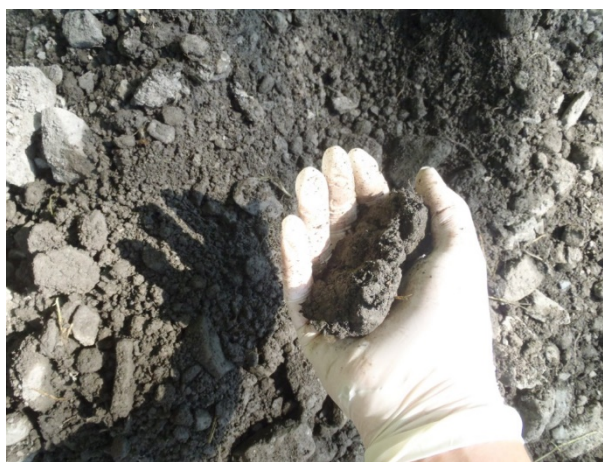
Obrázek 7 - Recyklovaná stmelená směs frakce 0/63 [13]
