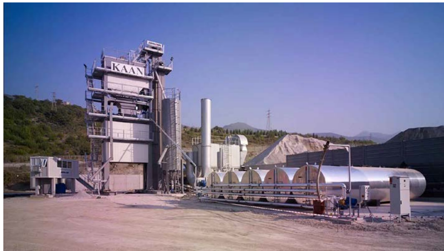
Obrázek 3 - Šaržová obalovna ABA 100–340 Unibatch [6]
