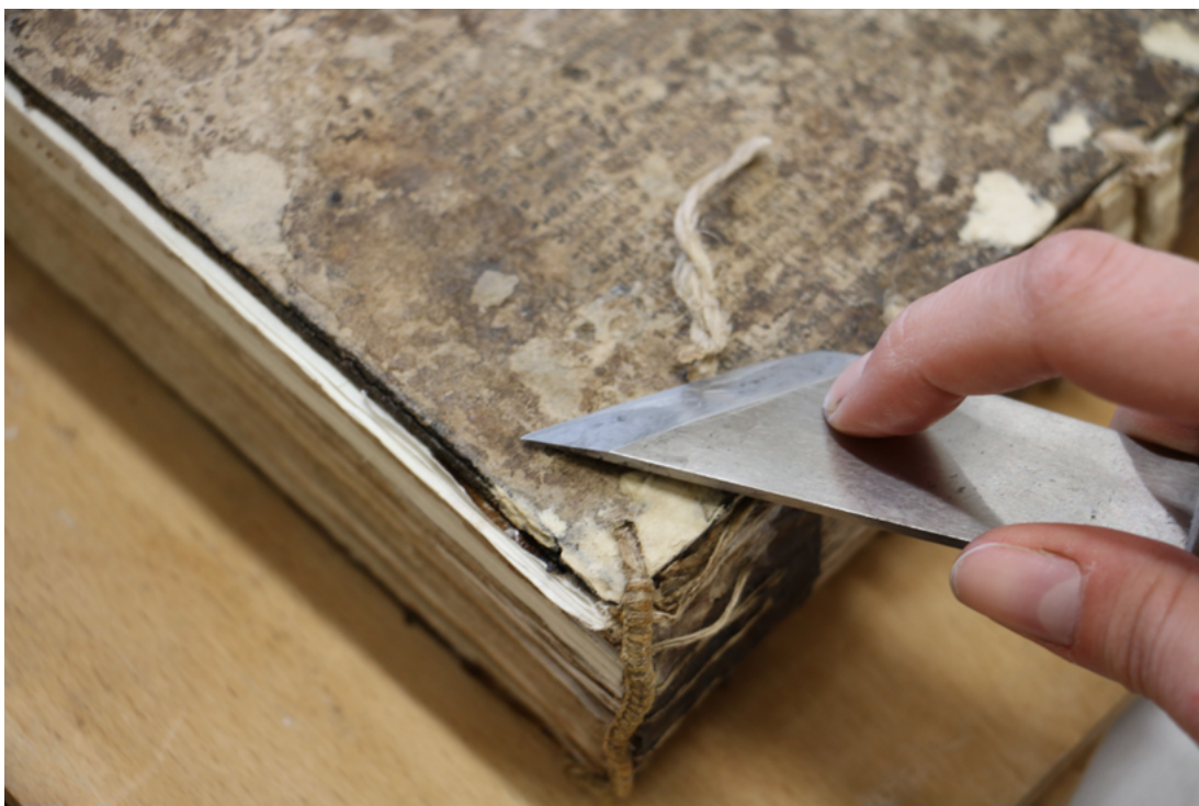
Obr.61 Zakrácení nasazeného vazu do desky
