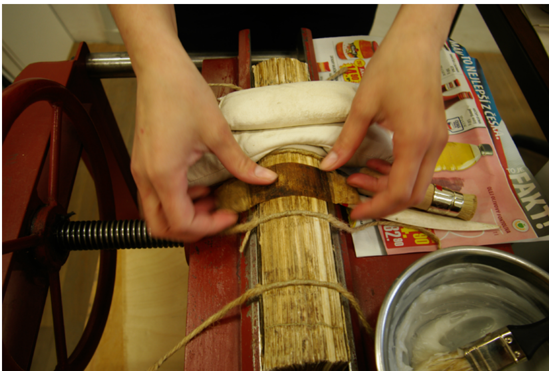
Obr.59 Aplikace pergamenových přelepů na zkulacený knižní blok
