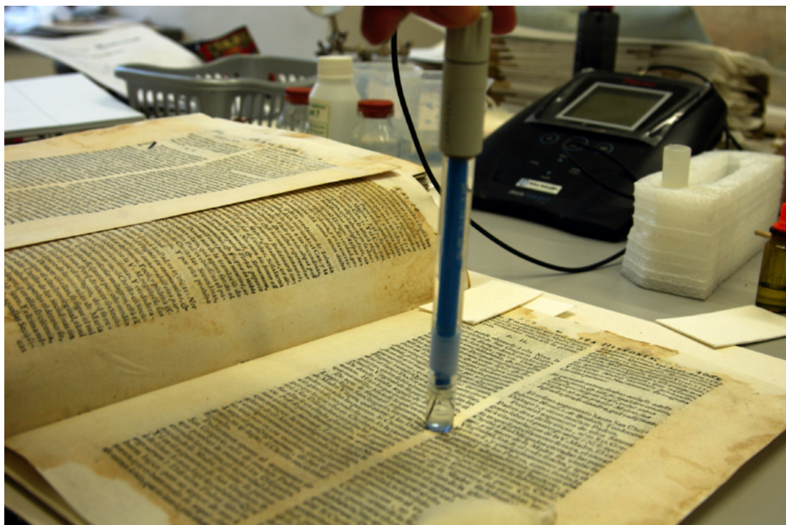
Obr.48 Měření pH po restaurování
