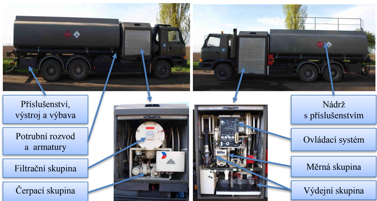
Obrázek 5 Rozmístění hlavní částí cisternového automobilu T 815 CAPL 16M
