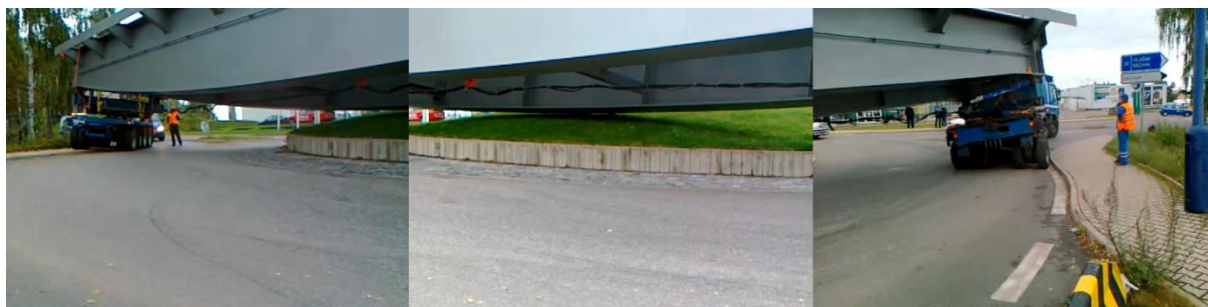
Obrázek 13 Nebezpečné naklonění při nájezdu na chodník Zdroj: (13), upraveno autorem
