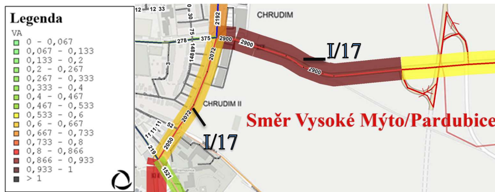
Obr. 15 Kartogram zatížení ve směru na Vysoké Mýto/Pardubice 3 Zdroj: OmniTRANS, autor
