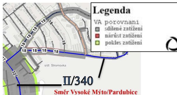
Obr. 24 Komparativní kartogram zatížení v okolí sídliště Větrník Zdroj: OmniTRANS, autor
