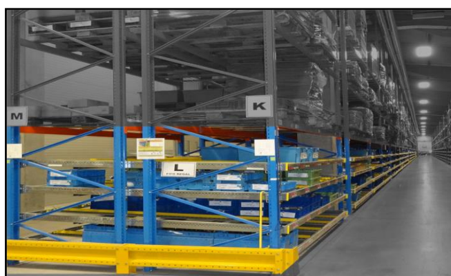
Obrázek 5 - Spádový regál, kde se dočasně uskládňuje materiál v přepravných
