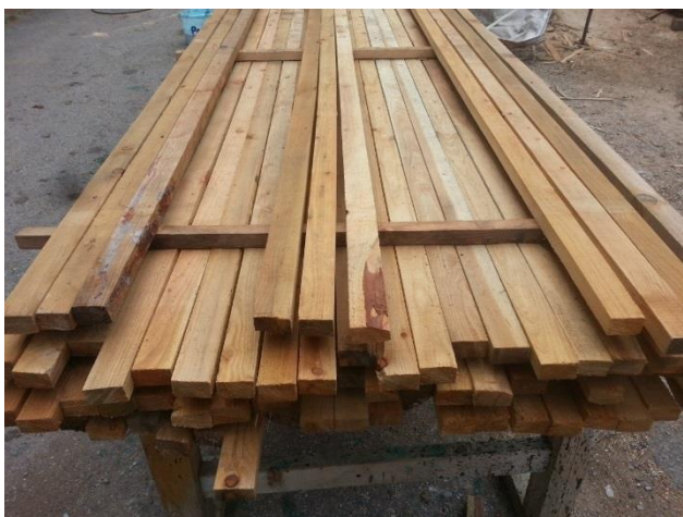
Obrázek 17 Proložení nákladu laťkami
