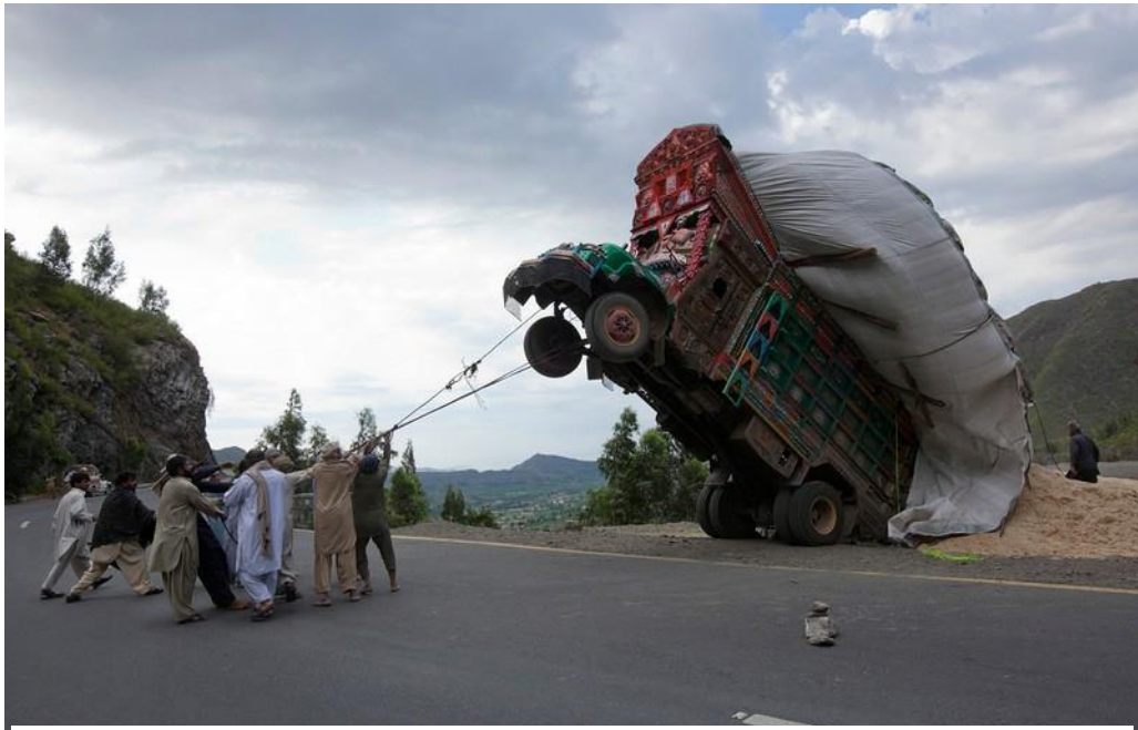
Obrázek 6 Převážené vozidlo vlivem nadměrné hmotnosti nákladu
