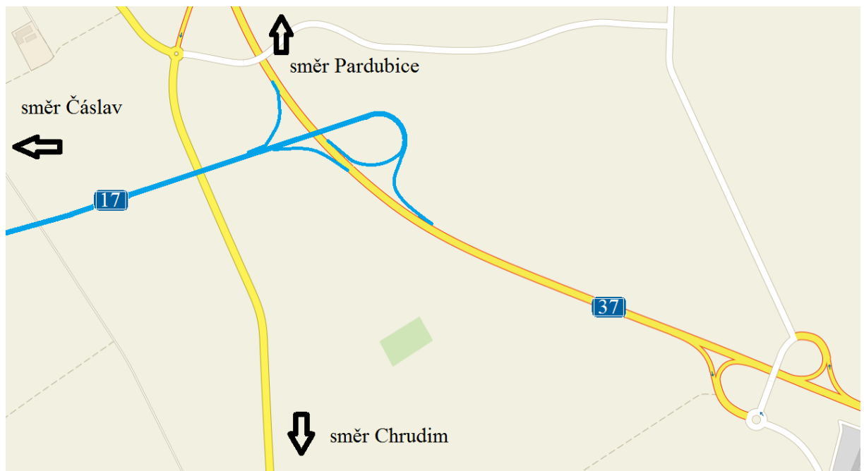
Obrázek 18 Návrh napojení na stávající silnici I/37
