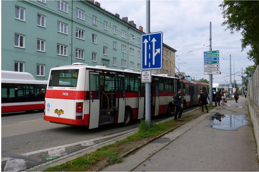
Obr. 3 Sjíždění vozů v zastávce Lesnická s nedostatečně dlouhou nástupní hranou
