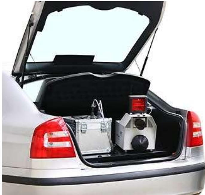
Obrázek 24 Ramer 10 T umístěný v zavazadlovém prostoru vozidla
