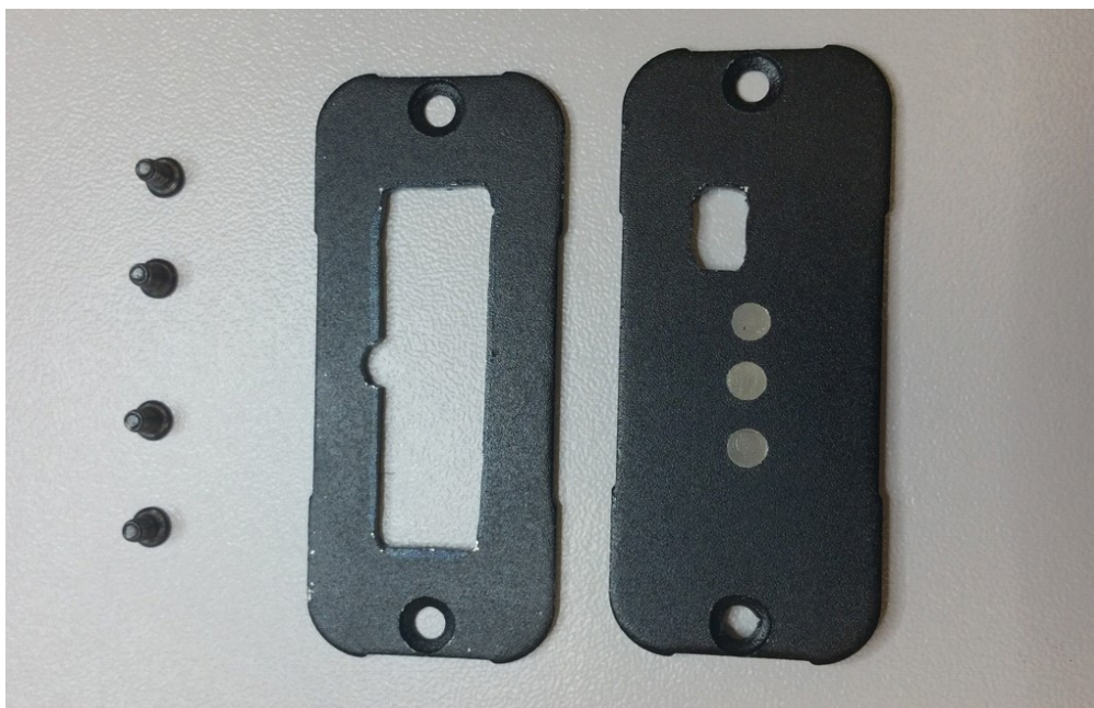
Obrázek 26 – ručně pilovaná krycí víčka pro krabičku
