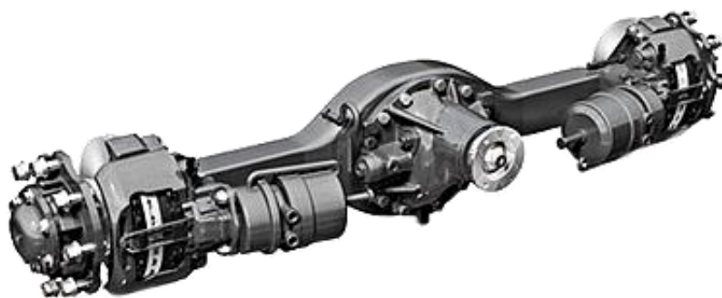
Obrázek 1: Tuhá náprava S130 od výrobce DANA. [4]
