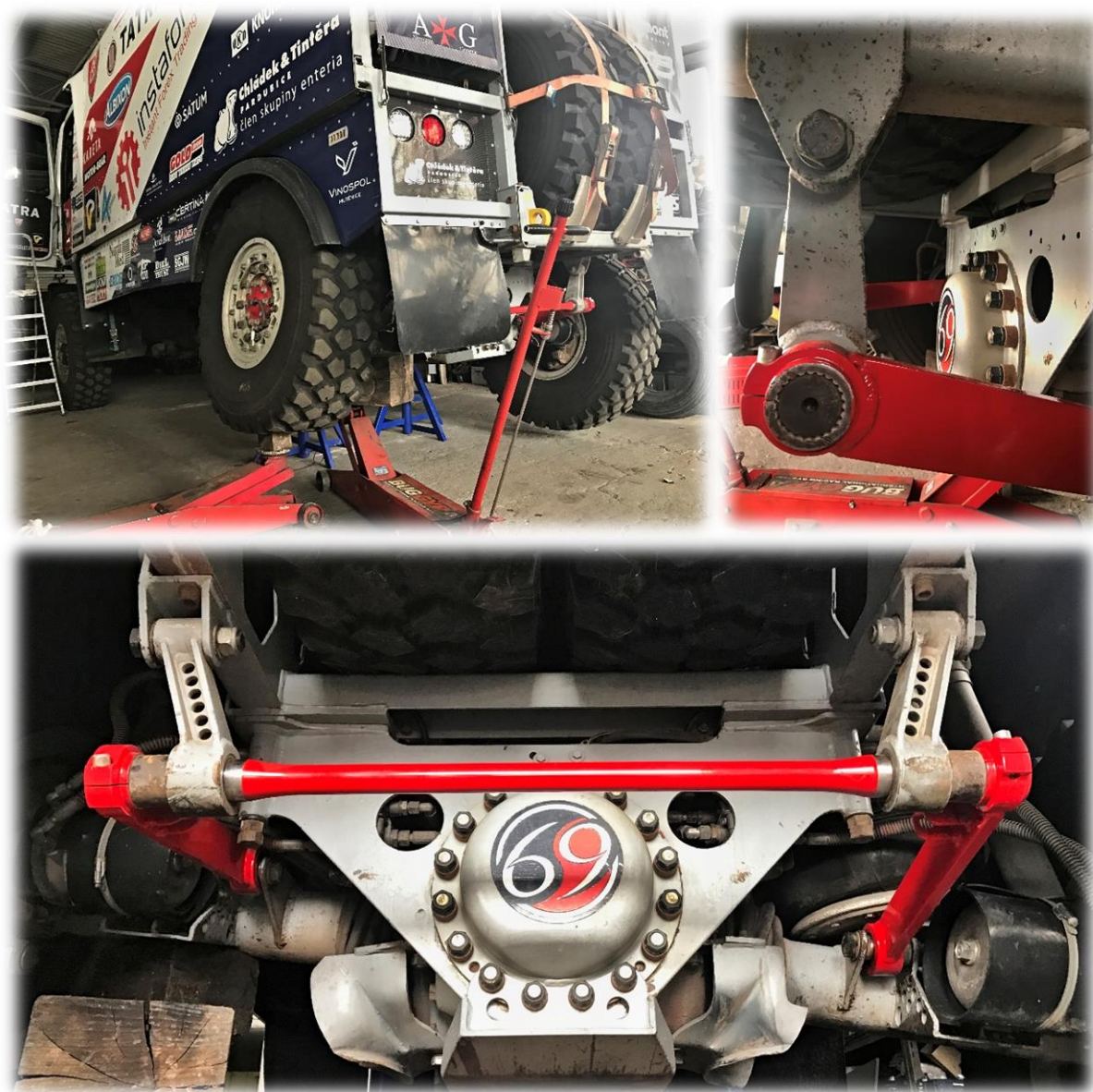
Obrázek 35: Měření nakroucené zkrutné tyče na závodním speciálu.
