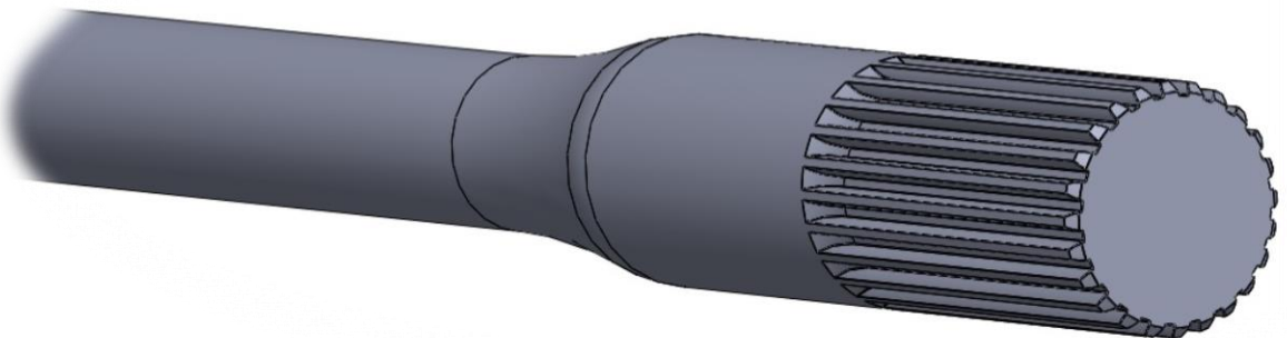
Obrázek 12: Navržená zkrutná tyč s evolventním drážkováním.
