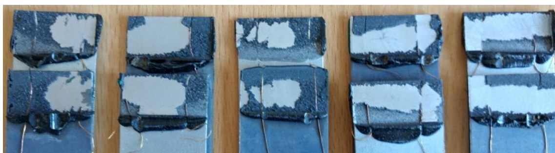
Obrázek 31 - Přetržené spoje Δ s lepidlem SikaPower 492G po zkoušce ve smyku
