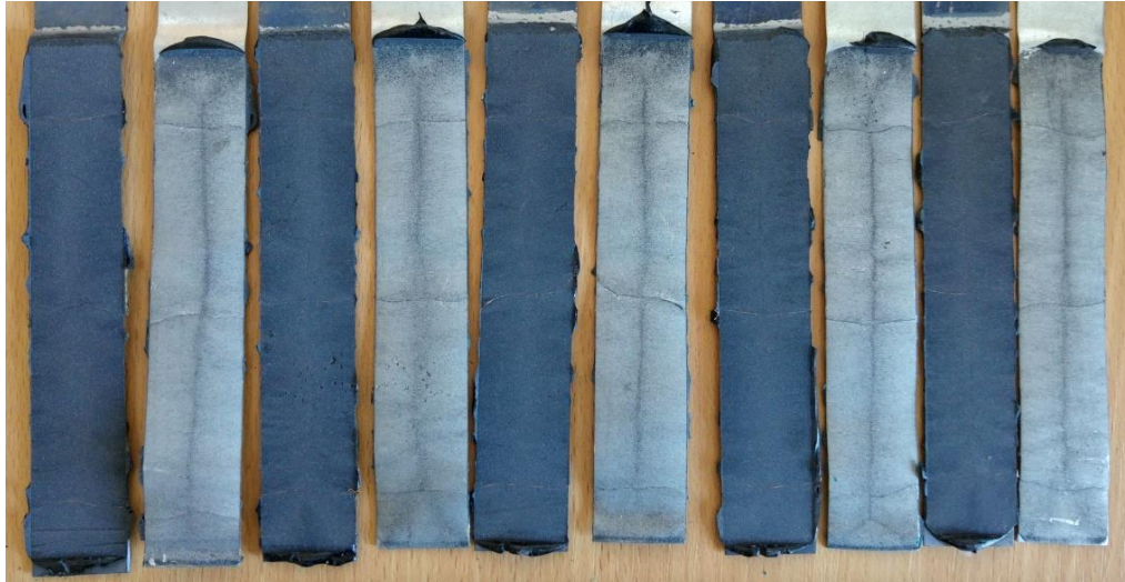
Obrázek 24 - Přetržené spoje ° s lepidlem SikaPower 492G po zkoušce v odlupu
