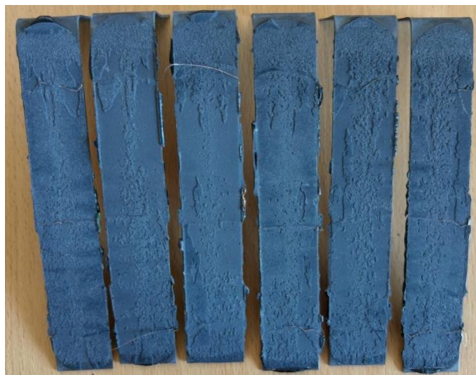
Obrázek 26 - Přetržené spoje * s lepidlem SikaPower 492G po zkoušce v odlupu
