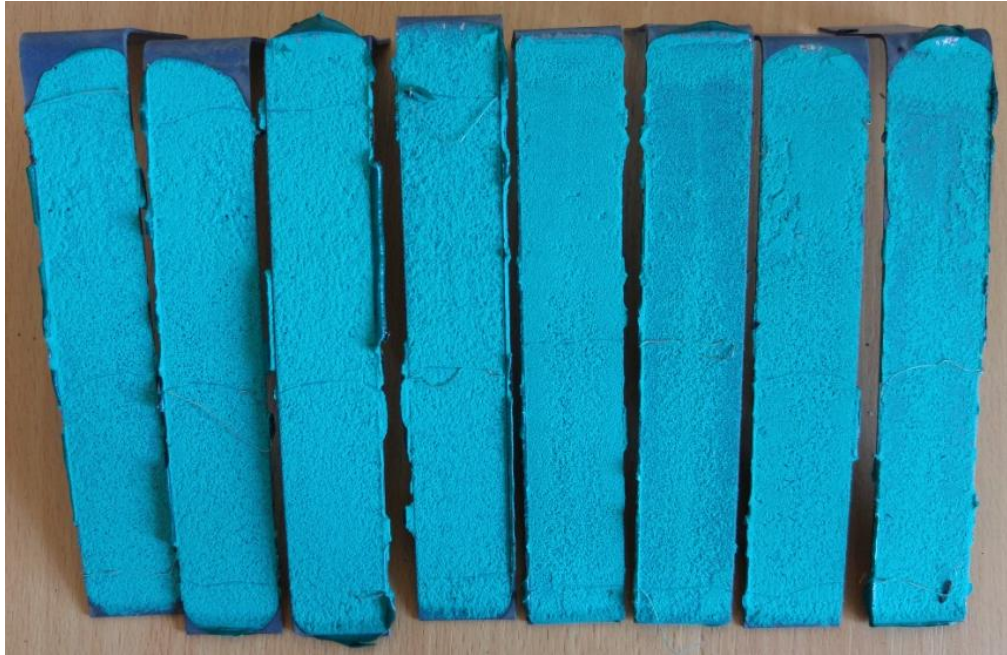
Obrázek 29 - Přetržené spoje * s lepidlem Betamate 1440G po zkoušce v odlupu
