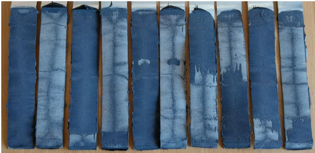
Obrázek 25 - Přetržené spoje - s lepidlem SikaPower 492G po zkoušce v odlupu
