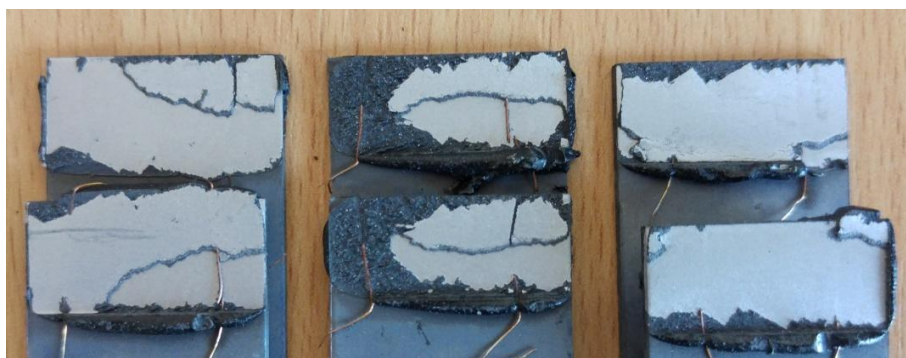
Obrázek 33 - Přetržené spoje □ s lepidlem SikaPower 492G po zkoušce ve smyku
