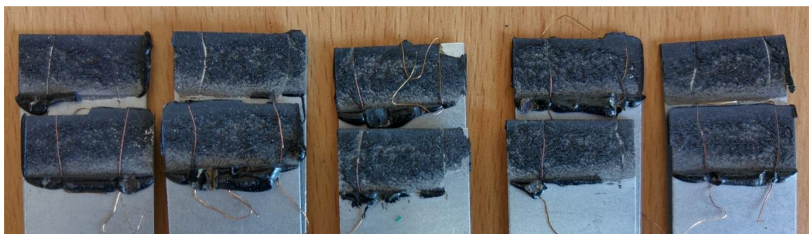
Obrázek 32 - Přetržené spoje / s lepidlem SikaPower 492G po zkoušce ve smyku
