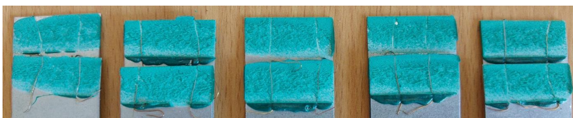
Obrázek 35 - Přetržené spoje / s lepidlem Betamate 1440G po zkoušce ve smyku
