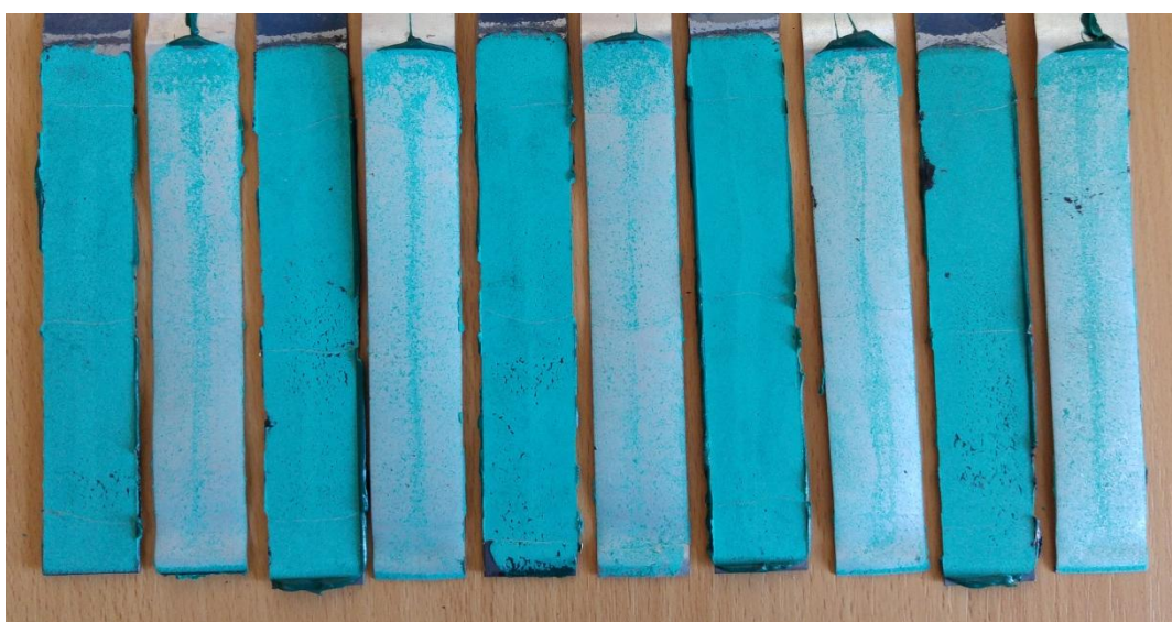
Obrázek 27 - Přetržené spoje ° s lepidlem Betamate 1440G po zkoušce v odlupu
