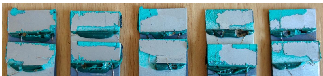
Obrázek 34 - Přetržené spoje Δ s lepidlem Betamate 1440G po zkoušce ve smyku
