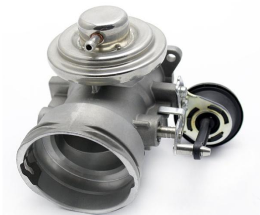
Obrázek 32: EGR ventil pneumaticky ovládaný[25]
