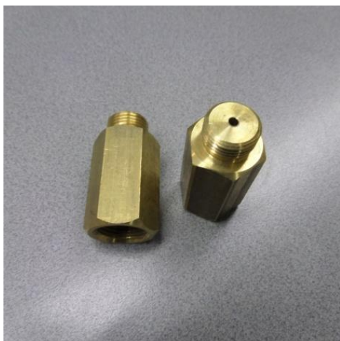
Obrázek 59: Lambdaspacer[Autor] Obrázek 60: Instalovaný Lambdaspacer ve výfuku[Autor]
