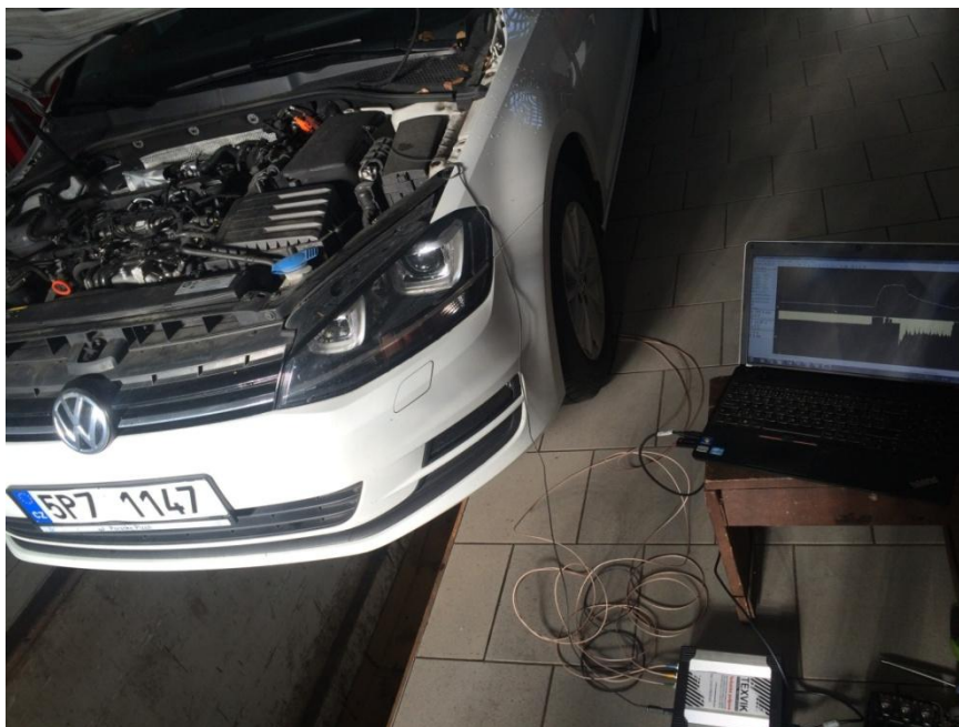
Obrázek 68: Měření EGR ventilu na vozidle VW Golf 1.6 Tdi[Autor]
