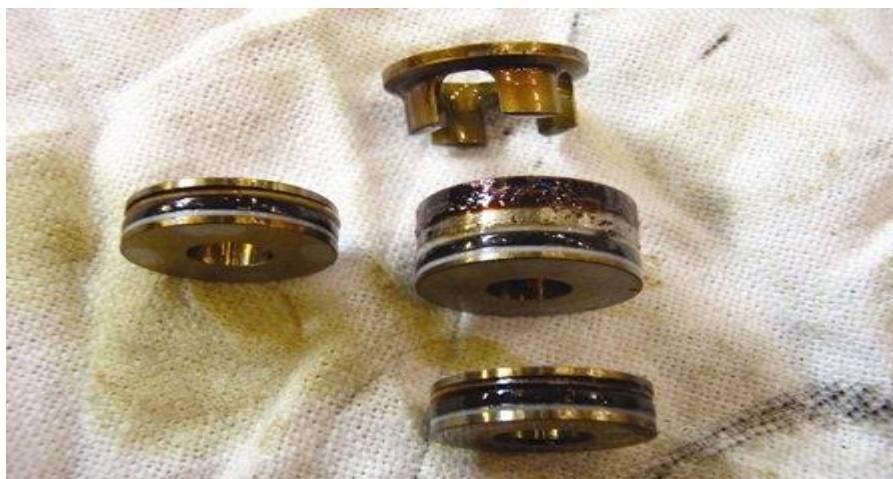
Obr. 3 – Ukázka úsad na hydraulickém prvku[10]
