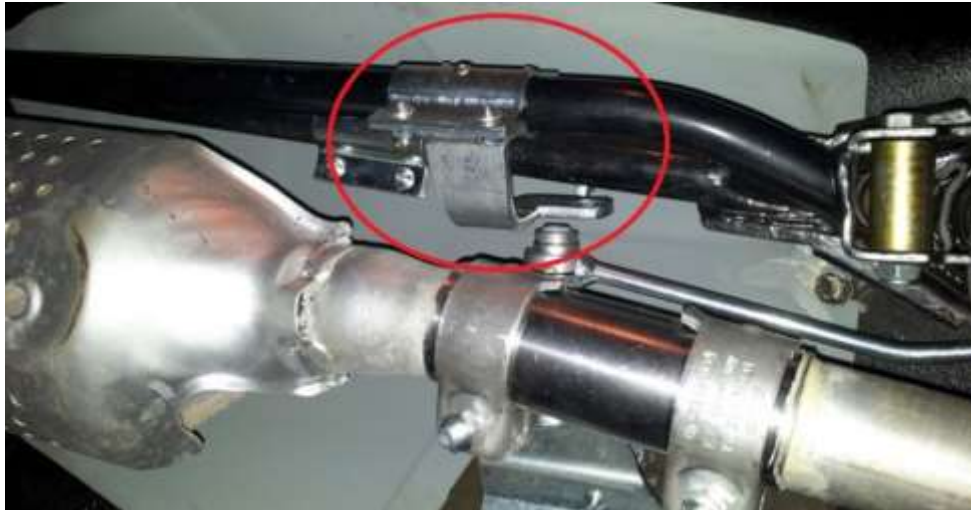
Obrázek 5. Zámek táhla řazení [10] – upraveno autorem
