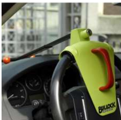
Obrázek 10. Bullock Defender – zámek volantu [14]
