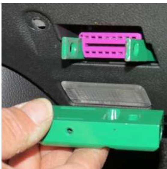
Obrázek 12. Construct OBD – Zabezpečení diagnostické zásuvky [6]
