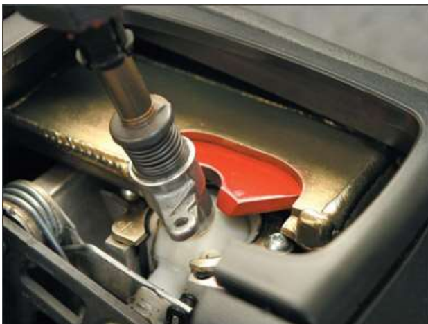
Obrázek 6. Zámek řazení Construct safetronic – mechanická část [12]
