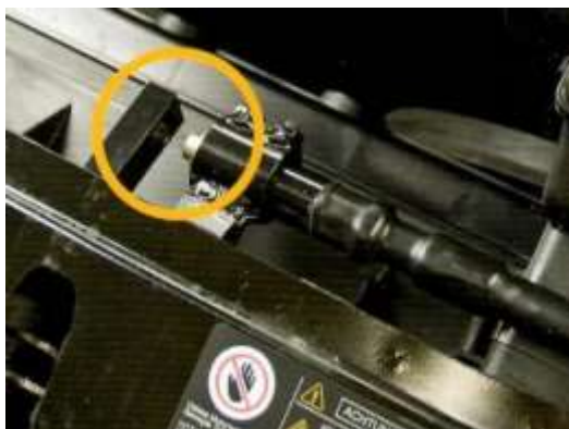
Obrázek 9. Construct Hood Lock – zabezpečení kapoty vozidla [6] – upraveno autorem
