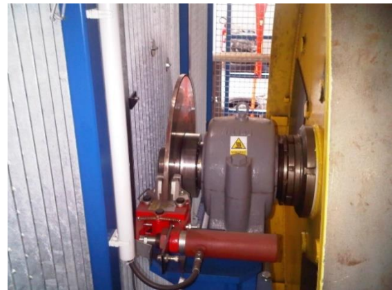
Obr. 29 – Část hnacího válce s brzdou
