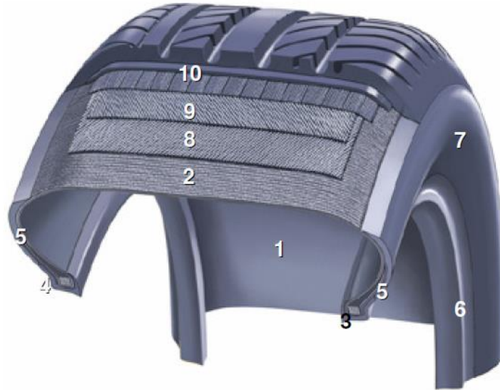
Obr. 4 - 1-vnitřní vložka, 2-kostra, 3-patní lano, 4-patní pryž, 5-výztužný pásek, 6-patka, 7-bočnice, 8-nárazník, 9-polyamidový nárazník, 10-běhoun [15]
