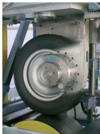
Obr. 24 - Umístění měřícího náboje od Kistleru [31]
