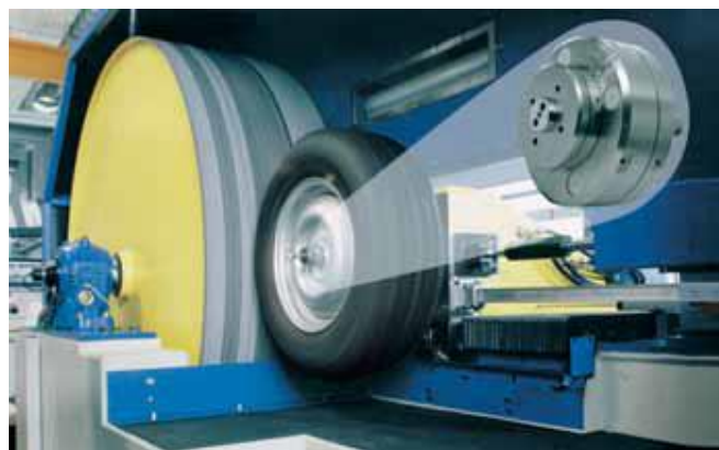
Obr. 25 - Umístění měřícího náboje od Kistleru [31]
