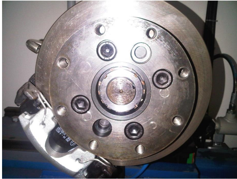
Obr. 32 – Druhá část adaptéru, v pozadí lze vidět brzdový kotouč a třmen
