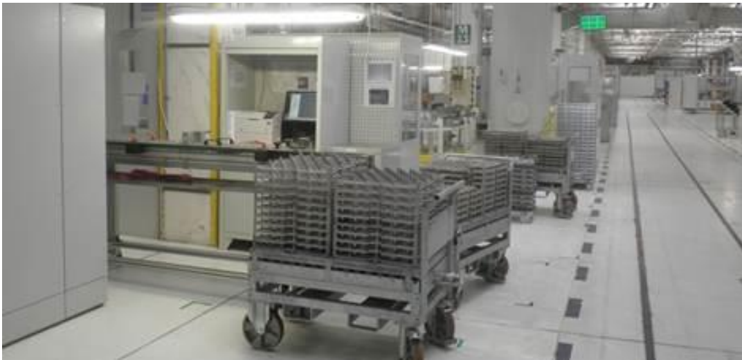
Obrázek 10 Vozík určený pro přepravu materiálu mezi pracovišti (ŠKODA AUTO, 2016)
