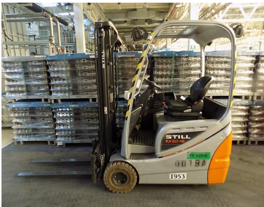
Obrázek 17 vysokozdvížený vozík s nosností 1,6 tun (ŠKODA AUTO, 2017a)
