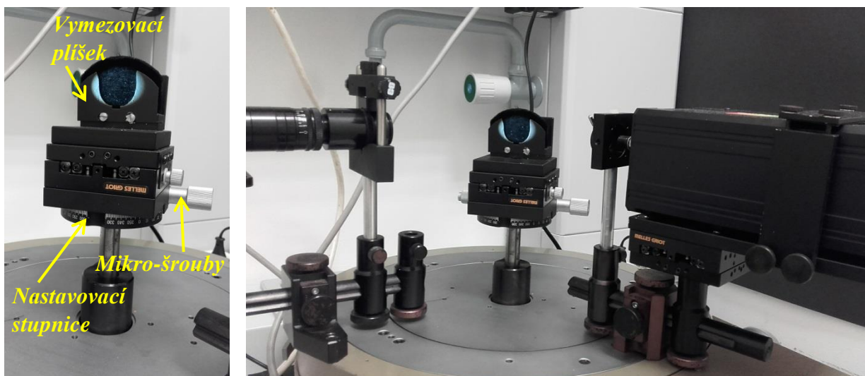
Obrázek 4.2.1.2.1 Otočný držák vzorku – Detail otočného držáku (vlevo) a ukázka postavení otočného držáku, vůči osvětlovací části a detektoru (vpravo)
