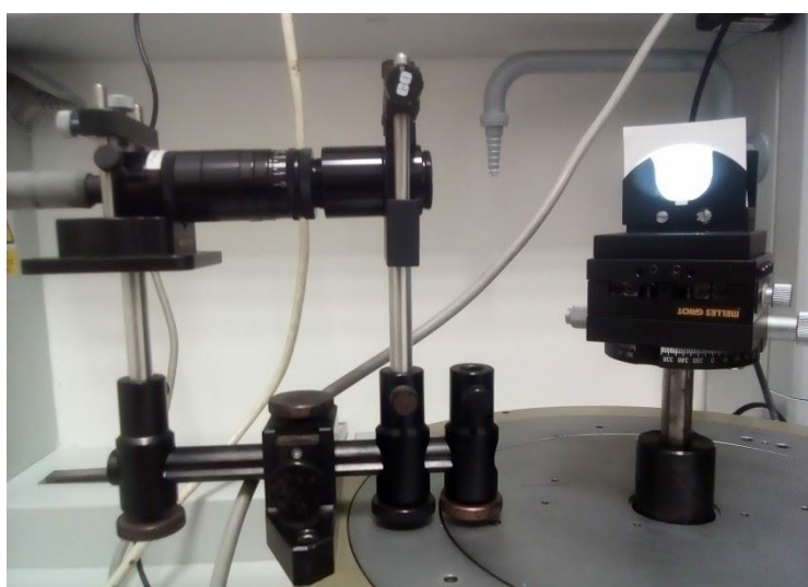
Obrázek 4.2.1.1.1 Optická soustava osvětlovací části gonio-spektrofotometru, z níž dopadá světelný svazek na vzorek
