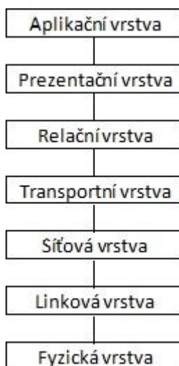
Obr. 1.6 – Referenční model ISO/OSI.
