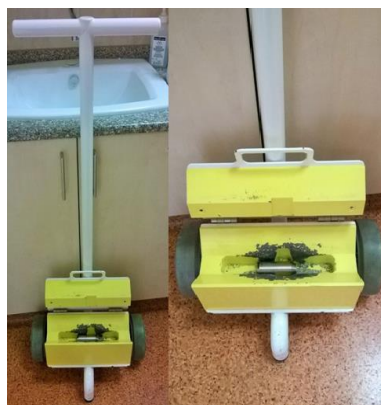
Obrázek 15 Olověný vozík pro přemístění radiofarmaka s olověným krytem na injekční stříkačku s radiofarmakem 15
