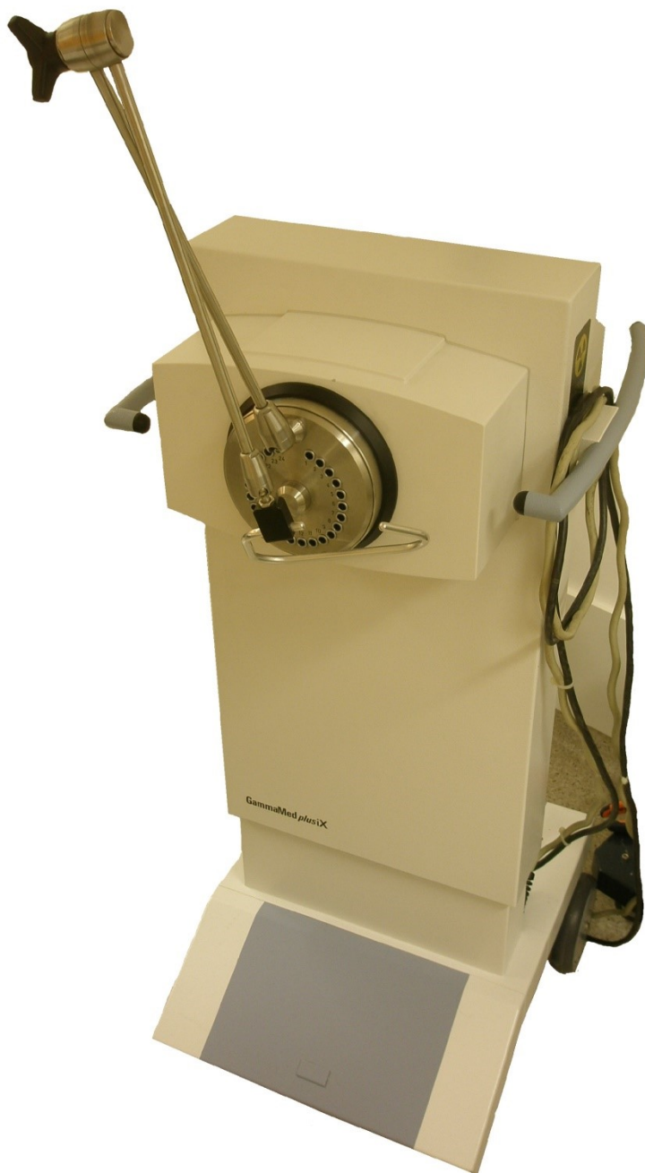
Obrázek 5 Automatický afterloadingový brachyterapeutický přístroj GammaMed ve fakultní nemocnici v Hradci Králové.
