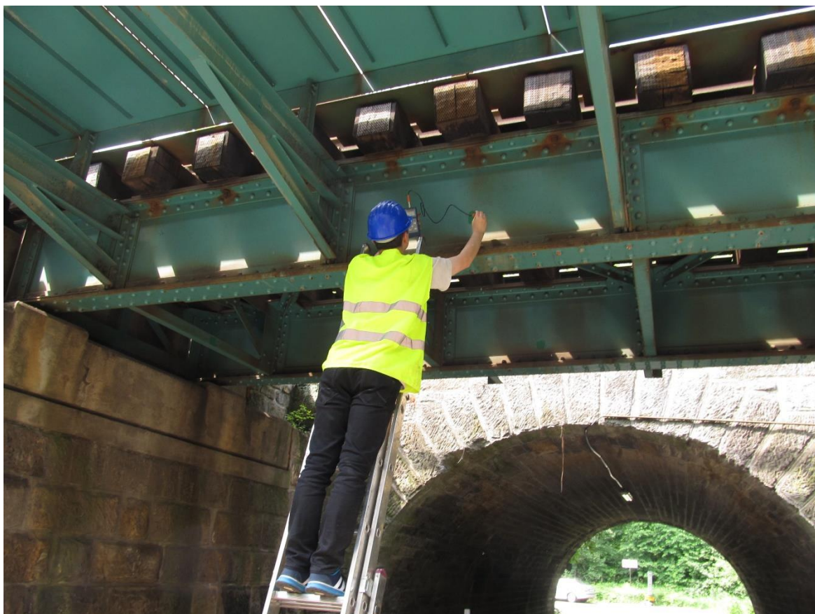
Fotografie 28 - měření stojny hlavního nosníku
