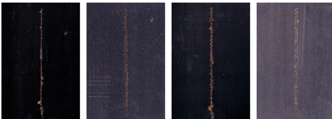
Obrázek 60 Worlée DUR D46 PANI/DEPH OKP = 4 %, 240 a 570 hodin s nátěrem, bez nátěru, komora SO 2
