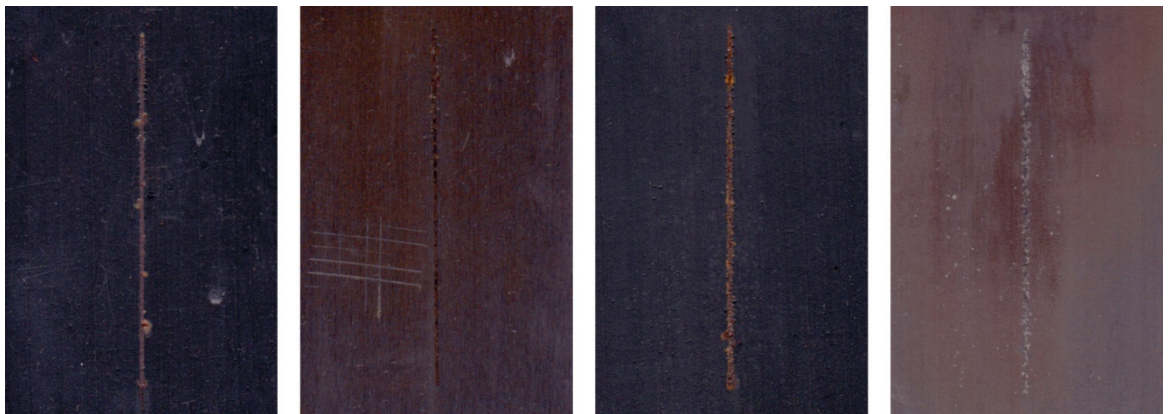
Obrázek 53 CH-S SU 671 W 60 PANI/DEPH OKP = 8 %, 240 a 570 hodin s nátěrem, bez nátěru, komora SO 2
