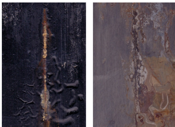
Obrázek 80 Worlée DUR D46 PANI/DEPH OKP = 12 %, 30 cyklů zrychlená cyklická korozní zkouška
