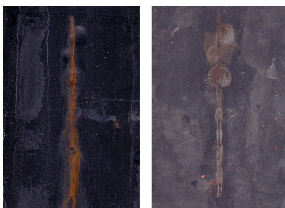
Obrázek 71 CH-S Epoxy 210 X 75 PANI/DEPH OKP = 12 %, 30 cyklů zrychlená cyklická korozní zkouška
