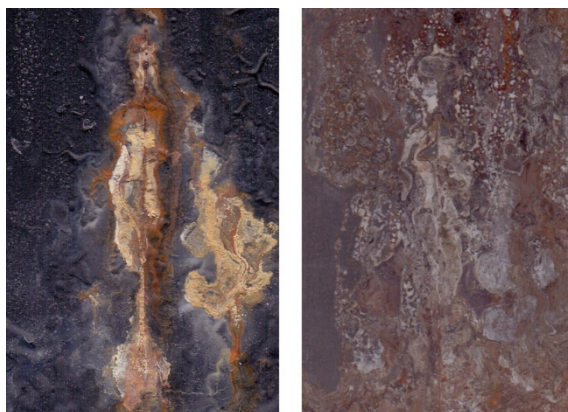
Obrázek 74 CH-S SU 671 W 60 PANI/DEPH OKP = 12 %, 30 cyklů zrychlená cyklická korozní zkouška
