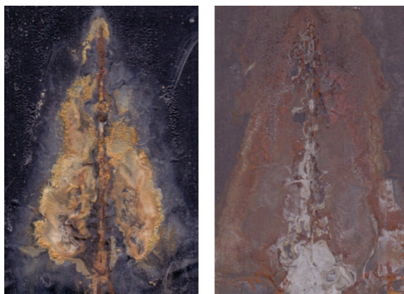
Obrázek 73 CH-S SU 671 W 60 PANI/DEPH OKP = 8 %, 30 cyklů zrychlená cyklická korozní zkouška
