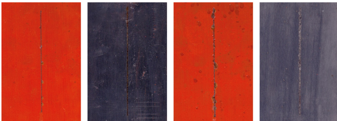
Obrázek 64 Worlée DUR D46 - Suřík OKP = 10 %, 240 a 570 hodin s nátěrem, bez nátěru, komora SO 2
