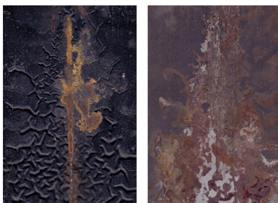
Obrázek 77 CH-S TU 497 X 55 PANI/DEPH OKP = 12 %, 30 cyklů zrychlená cyklická korozní zkouška
