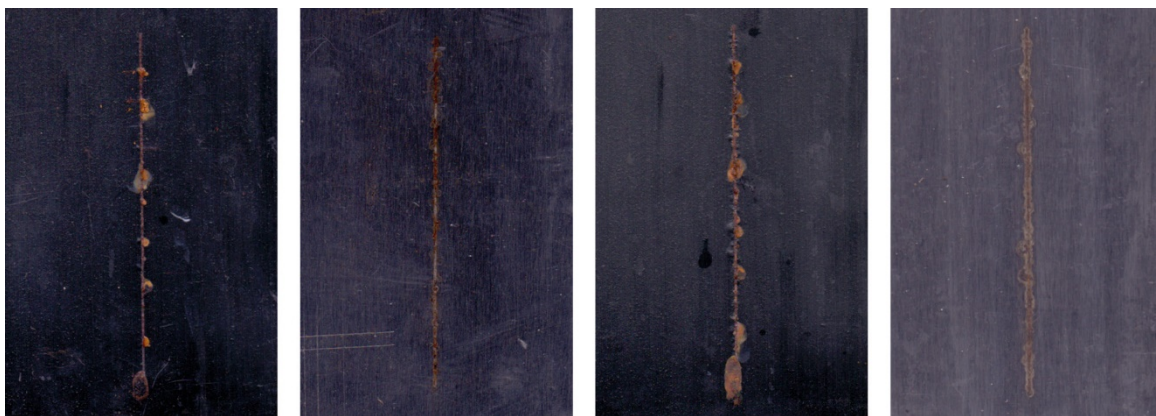
Obrázek 49 CH-S Epoxy 210 X 75 PANI/DEPH OKP = 8 %, 240 a 570 hodin s nátěrem, bez nátěru, komora SO 2
