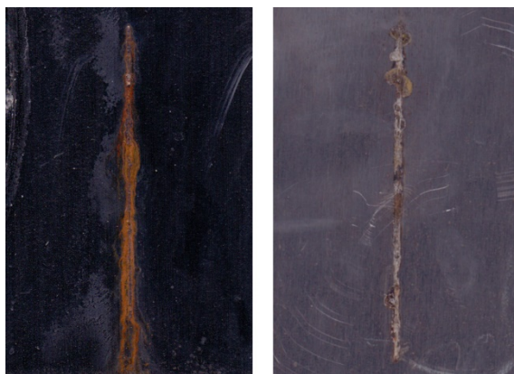
Obrázek 70 CH-S Epoxy 210 X 75 PANI/DEPH OKP = 8 %, 30 cyklů zrychlená cyklická korozní zkouška
