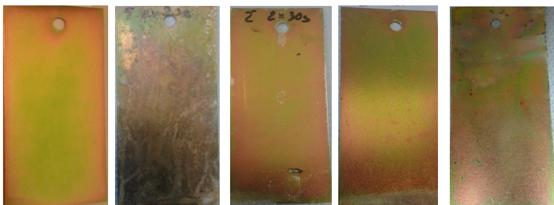
Obrázek 14: Vzorek opatřený žlutým povlakem na bázi šestimocného chromu v délce ponoru 2*30s
