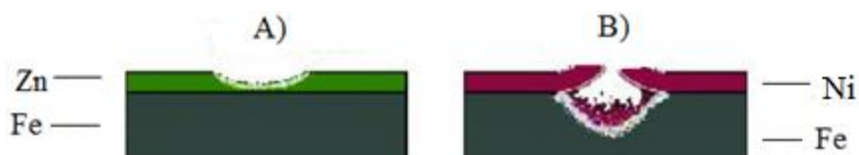
Obrázek 4: Schéma korozního napadení anodického (a) a katodického (b) povlaku
