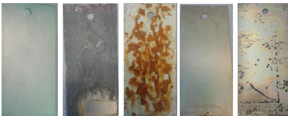
Obrázek 17: Vzorek opatřený modrým povlakem na bázi trojmocného chromu v délce ponoru 3*45s
