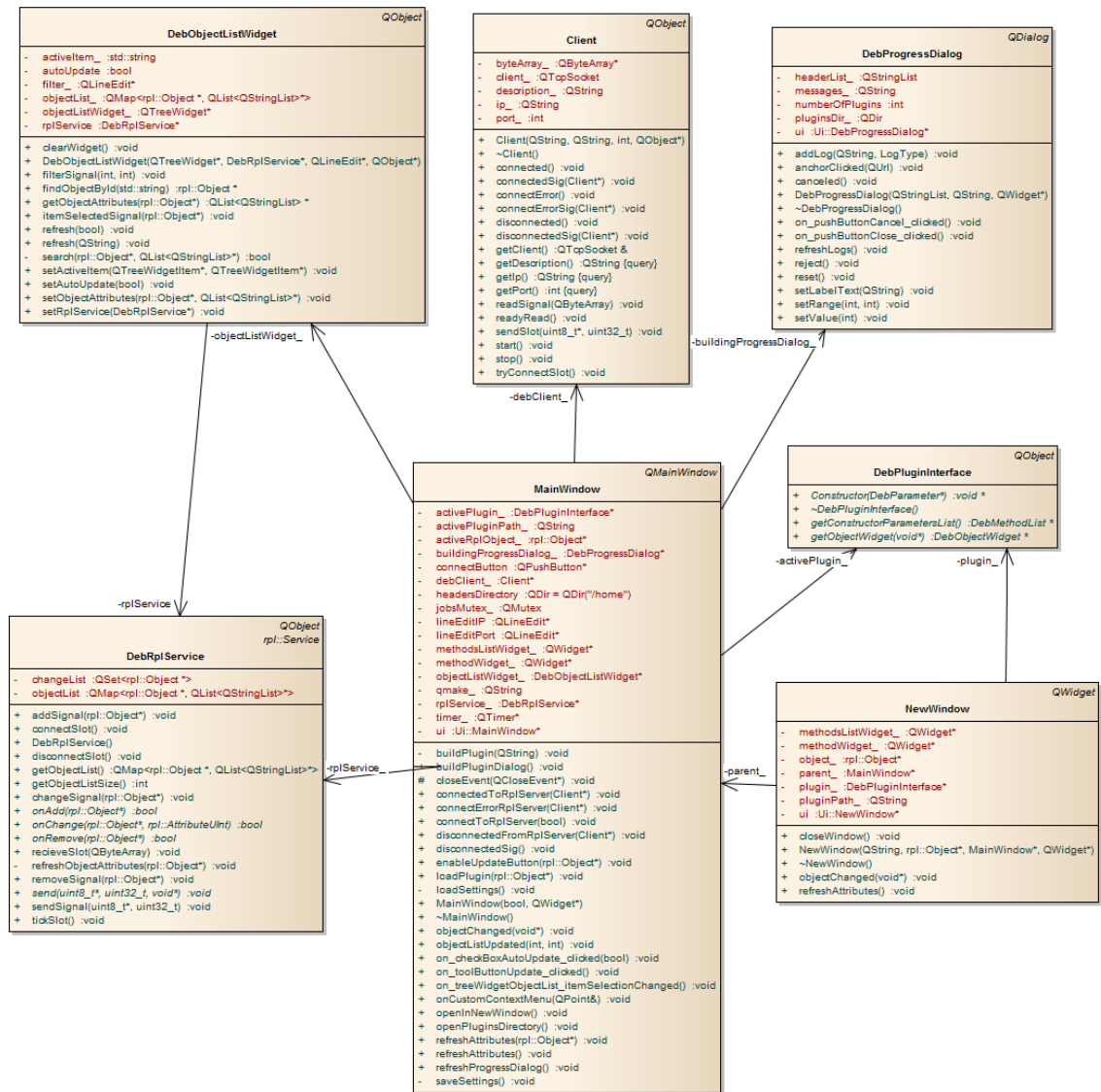
Obrázek 23 - Diagram tříd pro hlavní okno aplikace MainWindow
