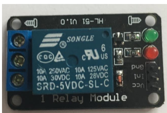
Obrázek 21 - Modul Relé na spínání LED pásku
