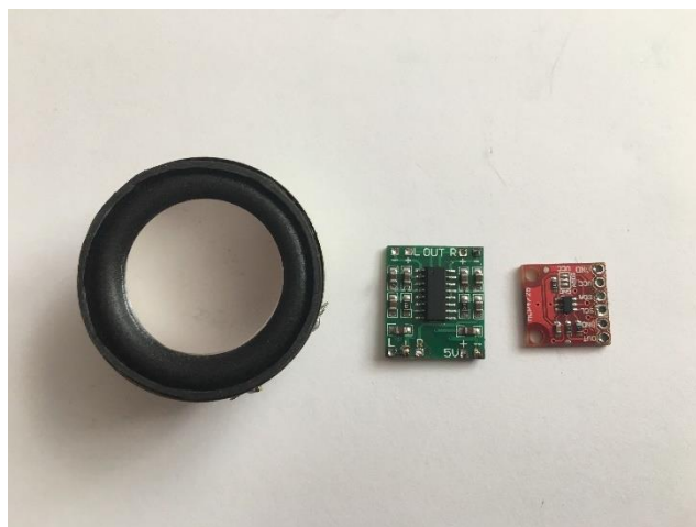
Obrázek 18 - D/A převodník (vpravo), zesilovač (uprostřed) a reproduktor (vlevo)
