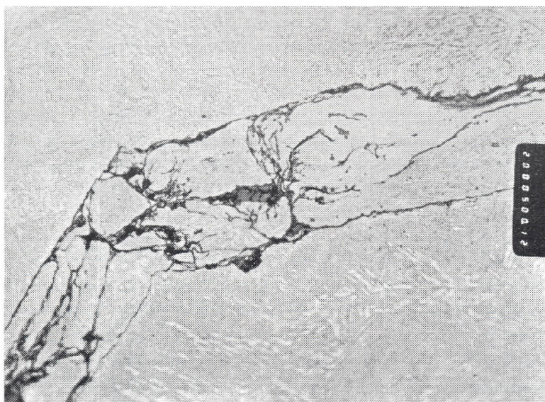
Obr. 6 Jemné síťové trhliny a vyloučených oxidických plén
