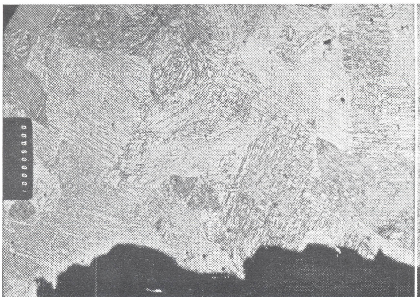
Obr. 4 Bainitická struktura - příčný řez, zv. 50 x
