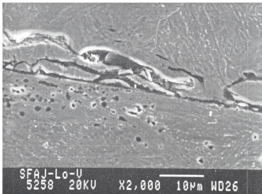
Obr. 7 Okolí trhliny a perezita materiálu
