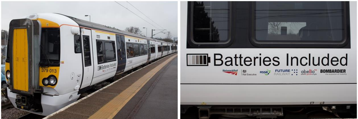
Obrázek 1 – Hybridní jednotka 379 na testovací trati vedoucí ze stanice Harwich International do stanice Manningtree [8]
