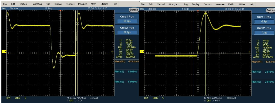
Obr. 3.3: Průběh napětí mezi fázemi na svorkách motoru (L-L) – nestíněný kabel 100m, tlumivka 2,2mH a průběh napětí mezi fázemi na svorkách motoru (L-L) – nestíněný kabel 100m, tlumivka 0,9mH
