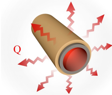
Obr. 2.3 Schematické znázornění sdílení tepla zářením
