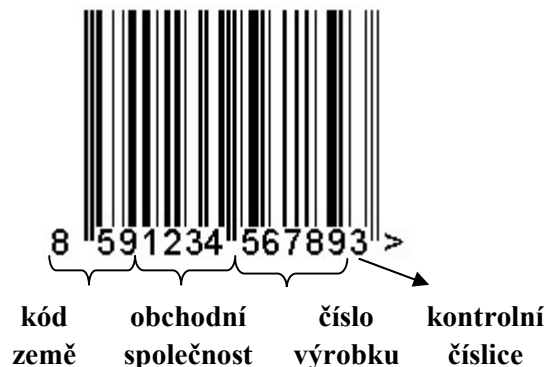
Obrázek 1 Vzhled čárového kódu EAN-13 ( http://www.combitrading.cz/technologie/druhy-a-typy-caroveho-kodu.html - upraveno autorkou)
