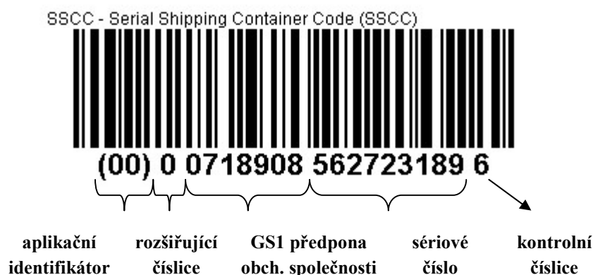
Obrázek 3 Vzhled SSCC kódu ( http://www.morovia.com/kb/Serial-Shipping-Container-Code-SSCC18-10601.html - upraveno autorkou)
