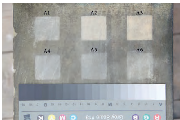
Obr. 6 Čištění mikropískováním, vzorek A1–A6. (Foto J. Ďoubal, 2012)
