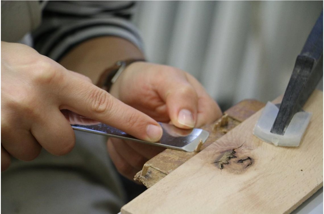
fotografia 67 – Dopĺňovanie a orezávanie drevených výplní na doske
