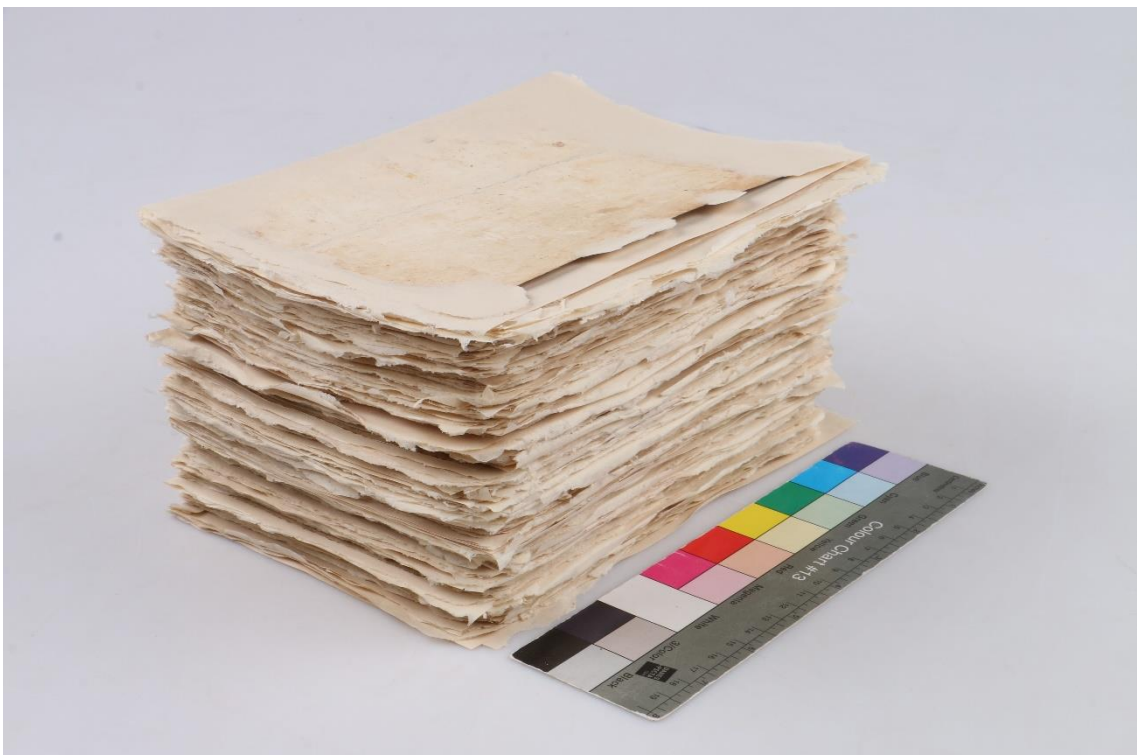
fotografia 56 – Doplnené a naskladané dvojlisty knižného bloku
