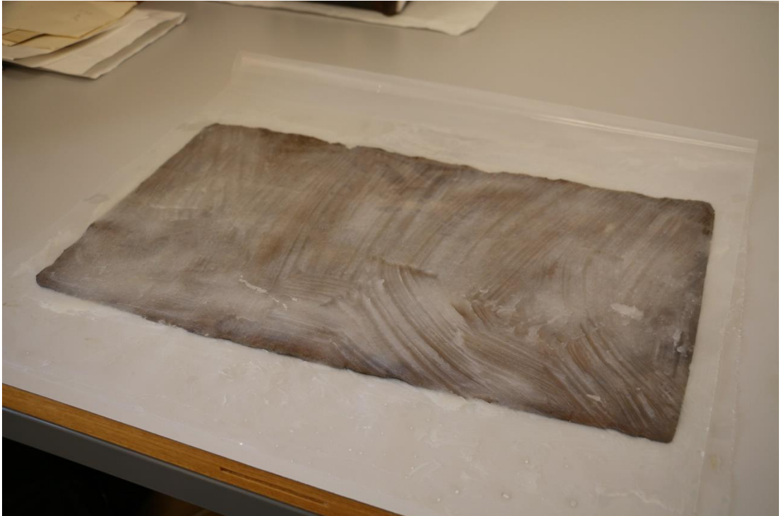
fotografia 87 – Prevlhčovanie usne pšeničným škrobom
