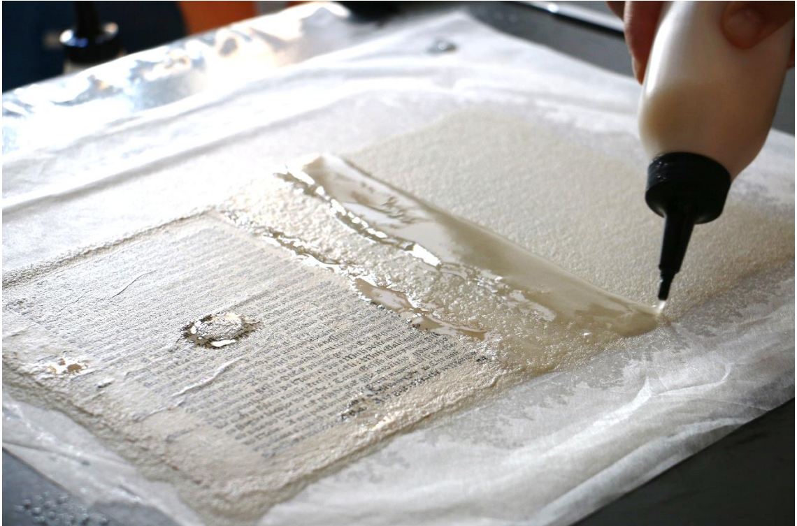
fotografia 53 – Dolievanie papierovinovou suspenziou na odsávacom stole
