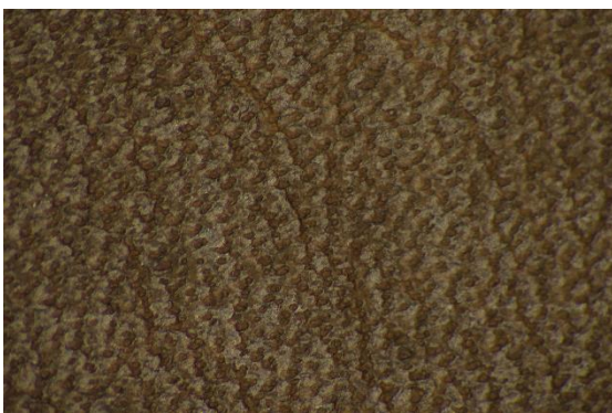
obr. 9 Mikroskopická fotografia analógovej farbenej usne
