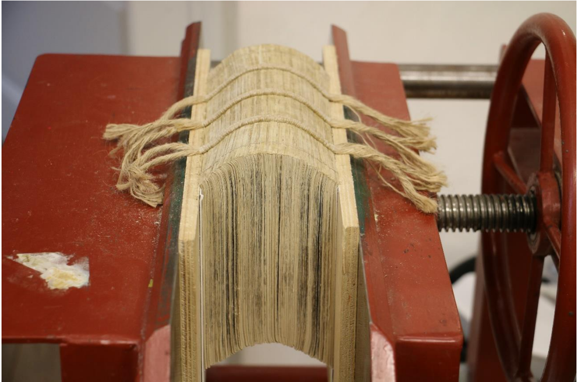
fotografia 65 – Doguľacovanie knižného bloku v oklepávačke
