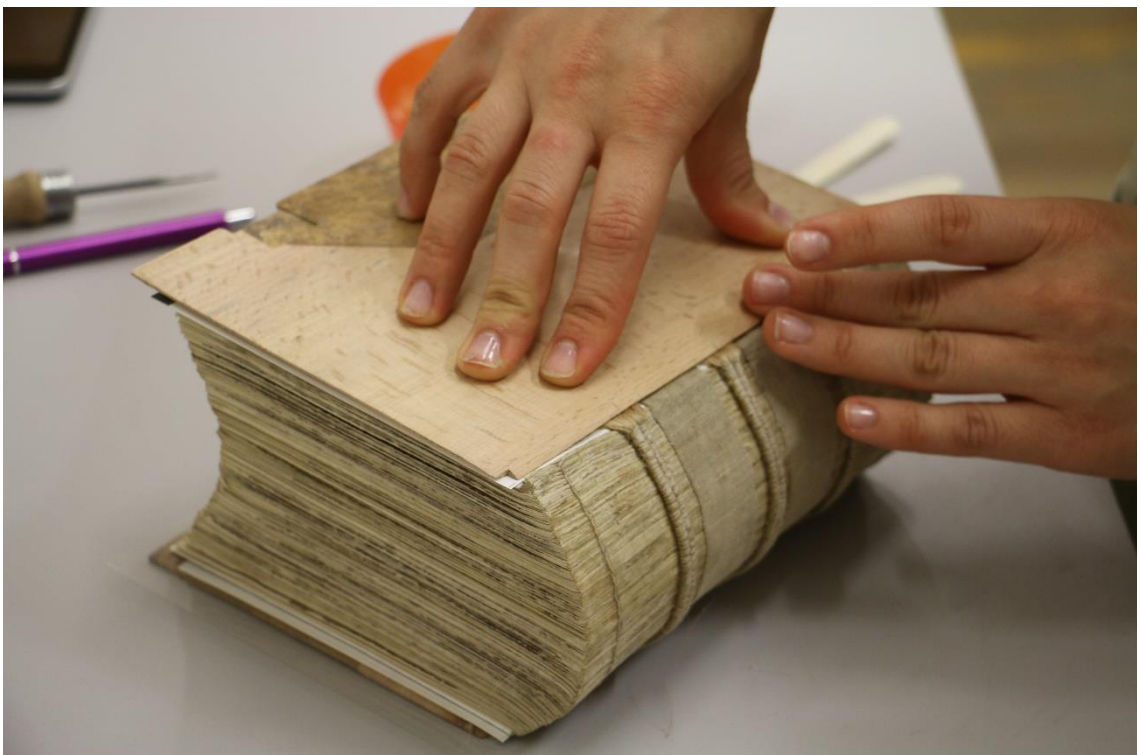
fotografia 82 – Nasadzovanie dosky na knižný blok
