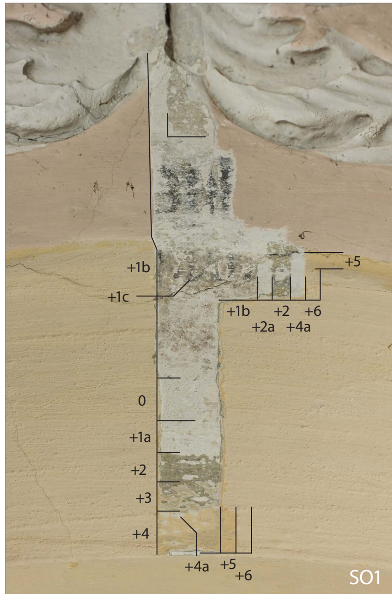
Obr. 41 Výjev K2 – sonda SO1 – stratigrafie omítkových vrstev – vrstva 1 obsahuje souvrství nápisu, následují mezivrstvy vápenných nátěrů s barevnými hlinkami
